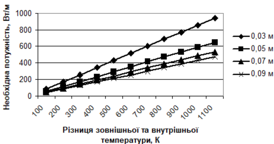
Рис. 4.4. Залежності максимальної погонної потужності нагрівачів ТЕП з КПТП від максимальної зміни температури та товщини шару теплоізоляції
