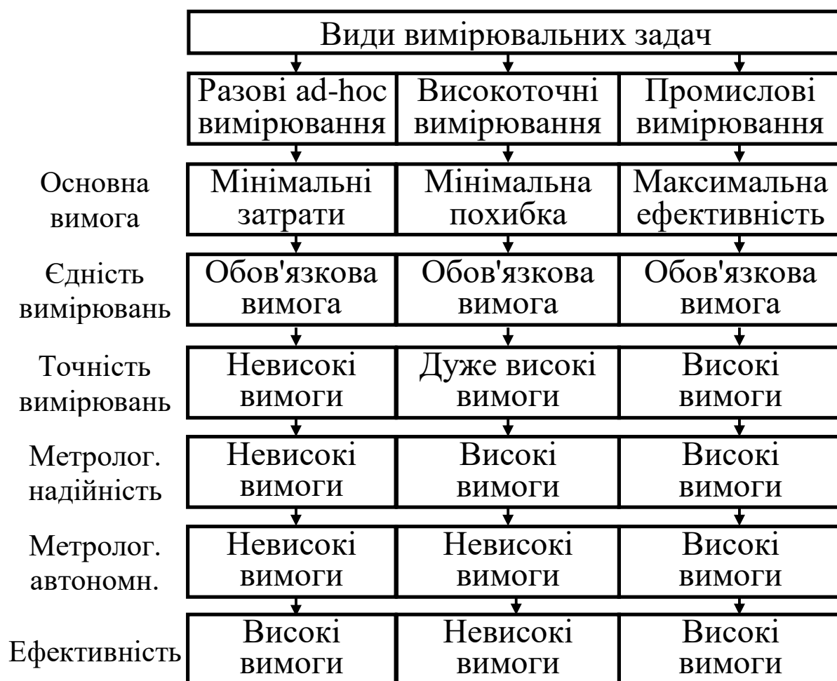
Рис. 2.1. Типові види задач, які постають перед розробником вимірювальних приладів і систем, а також аналіз вимог до них
