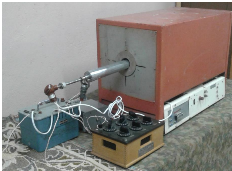
Рис. 5.13. Зовнішній вигляд станда із розміщеною у ньому ТЕП з КПТТ під час дослідження бездемонтажного методу визначення похибки ТЕП у процесі експлуатації
