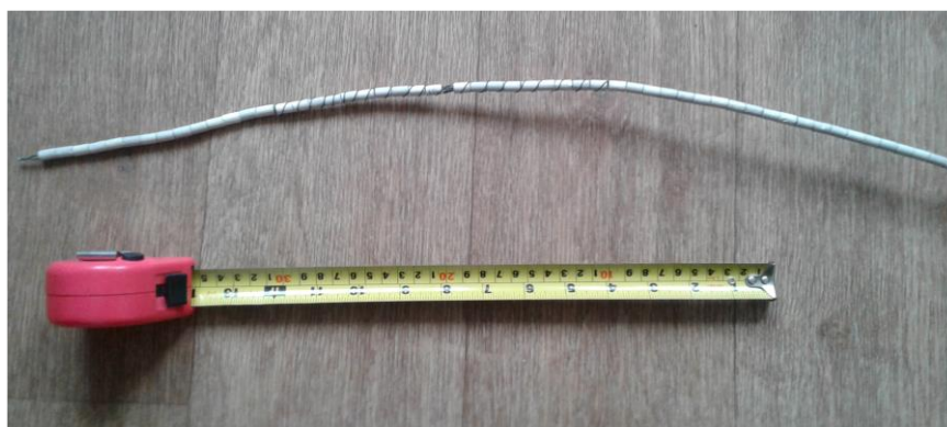
Рис. 5.15. Зовнішній вигляд вузла, що містить ТП 2 і 4 та нагрівач 3
