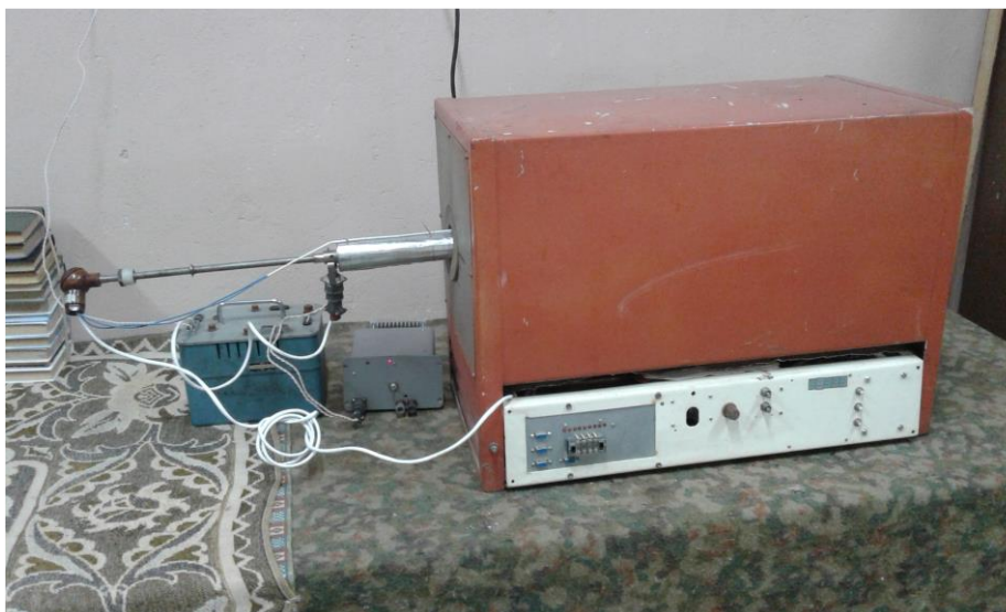
Рис. 5.11. Вигляд багатозонної печі із закріпленим додатковим ТЕПД та зміщеним стандартним ТЕП
