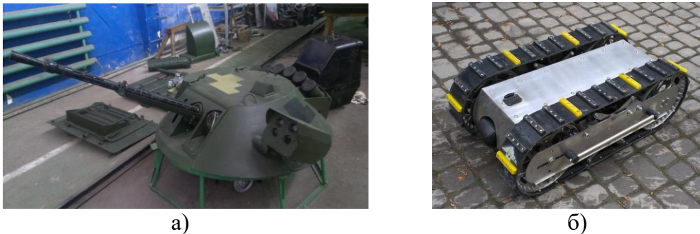
Рис. 6. Фото розробок із застосуванням БЕП: а) башта бронетранспортера, б) роботизований комплекс для виконання наземних завдань
