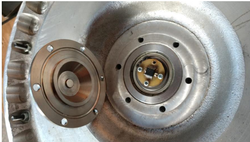
Рис. 5.13. Енкодер, інтегрований в корпус мотор-колеса роботизованого комплексу
