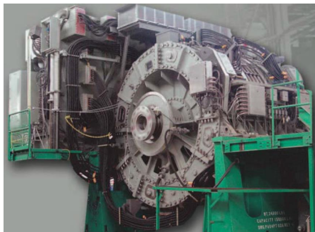
Рис. 1.4. 36,5 МВт тяговий БЕП судна на базі електричної машини з ПМ [72]
