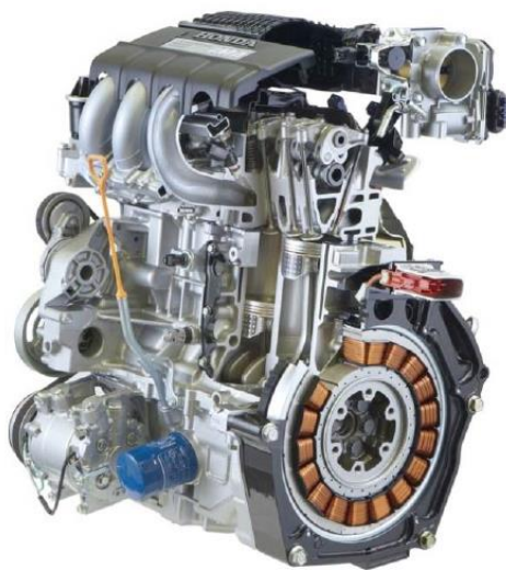
Рис. 1.3. Вигляд електричної машини з ПМ, яка асистує ДВЗ в конфігурації CR-Z гібридного електромобіля фірми Honda [72]
