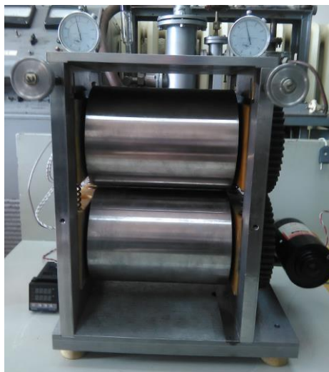
Рис. 5.17. Вальцювальна машина з БЕП на базі СМППМ
