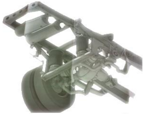
Рисунок 15 - Схема оригінальної задньої пневмо-ресорної підвіски автобуса ГУР А407, конструкції ВАТ «Укравтобуспром»
