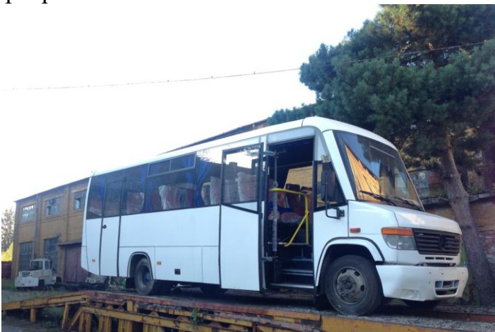
Рисунок 14 - Автобус ГУР А407, на якому проводились дорожні випробування на рівень вібронавантажених сидінь водія та пасажирів
