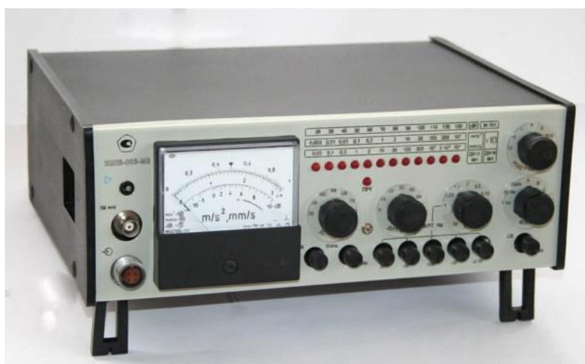
Рисунок 4.2 – Прилад для вимірювання шуму та вібрації ВШВ-003
