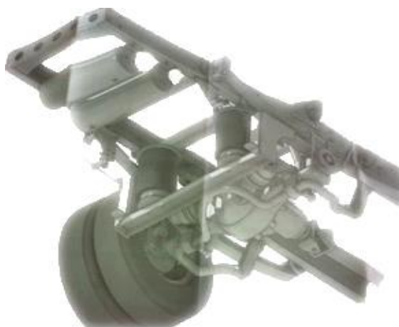
Рисунок 4.8 - Схема оригінальної задньої пневмо-ресорної підвіски автобуса ГУР А407, конструкції ВАТ «Укравтобуспром»
