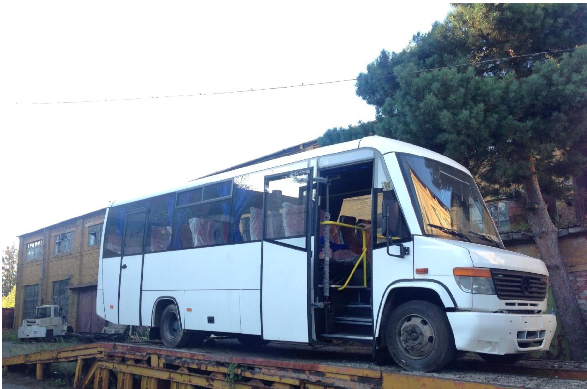
Рисунок 4.1 – Автобус «ТУР» А407, на якому проводились дорожні випробування на рівень вібронавантаженості сидінь водія та пасажирів
