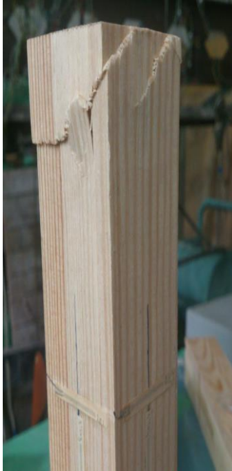
Рис. 2.3 – Найхарактерніші види руйнування призм
