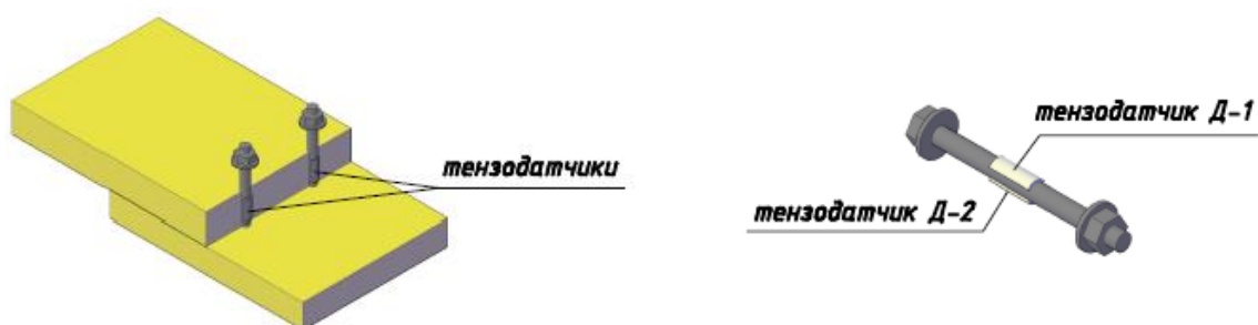
Рис. 2.6– Схема розміщення тензорезисторів на болтах
