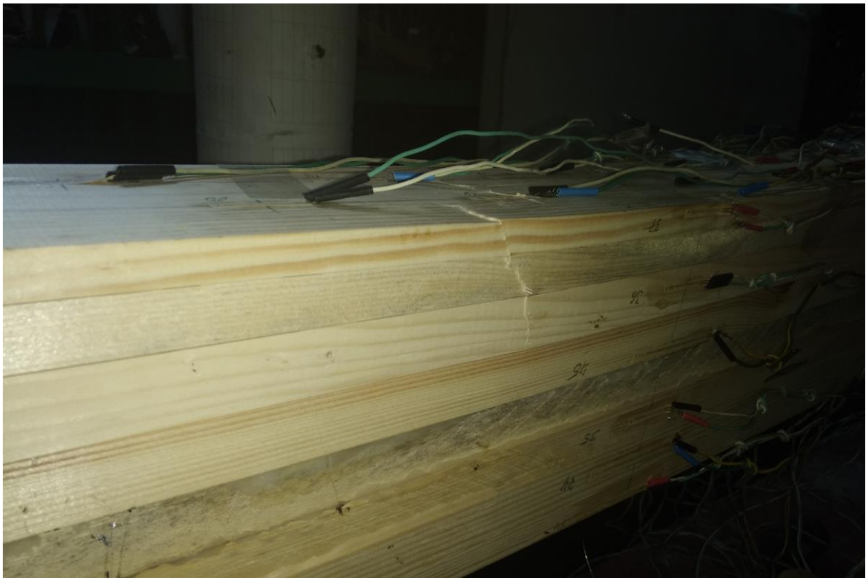
Рис. 5.1 – Утворення складок у стиснутій зоні в елементах з клеєної деревини за роботи на прямий згин
