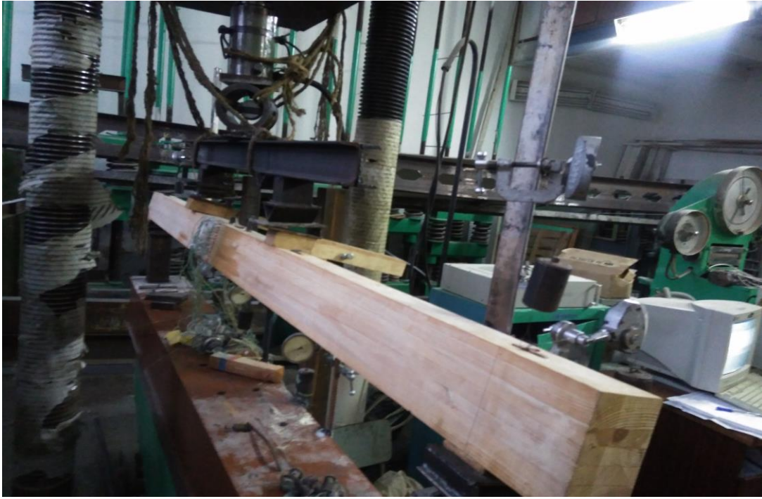
Рис.4.14 – Експериментальні випробування балок з клеєної деревини за КОСОГО ЗГИНУ
