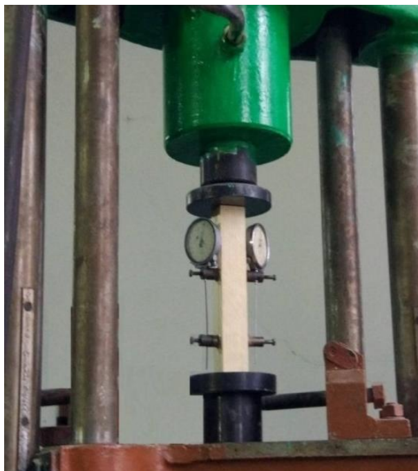
Рис.3.4 – Випробування зразків за малоциклового повздовжнього стиску а – з цільної деревини; б – з клеєної деревини
