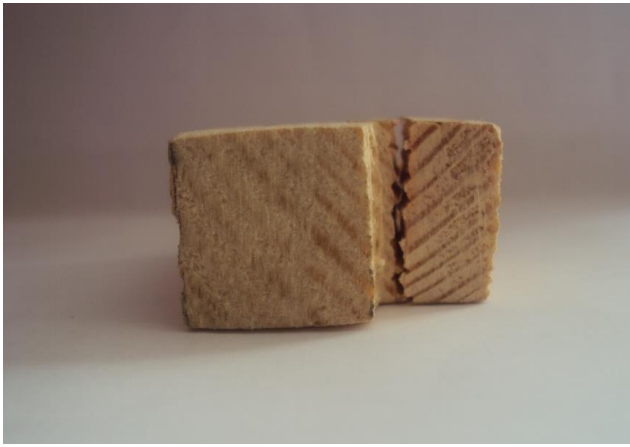
Рис..2.21 – Характер руйнування зразка КШ при повздовжньому сколюванні
