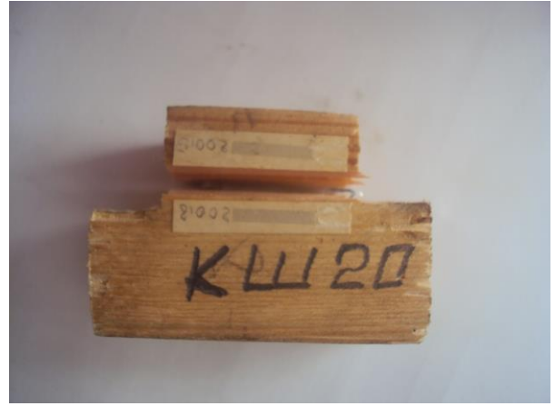
Рис..2.21 – Характер руйнування зразка КШ при повздовжньому сколюванні
