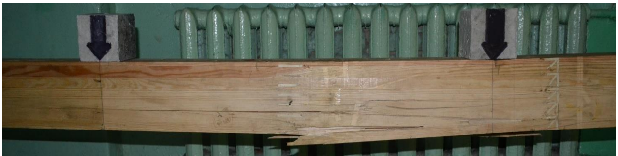
Рис. 5.9. Характер руйнування балок з клеєної деревини за прямого поперечного згину
