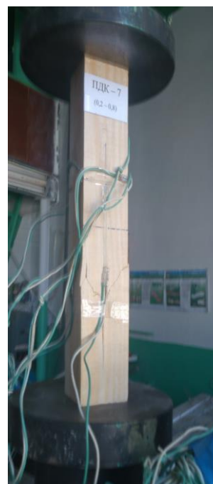
Рис.3.4 – Випробування зразків за малоциклового повздовжнього стиску а – з цільної деревини; б – з клеєної деревини
