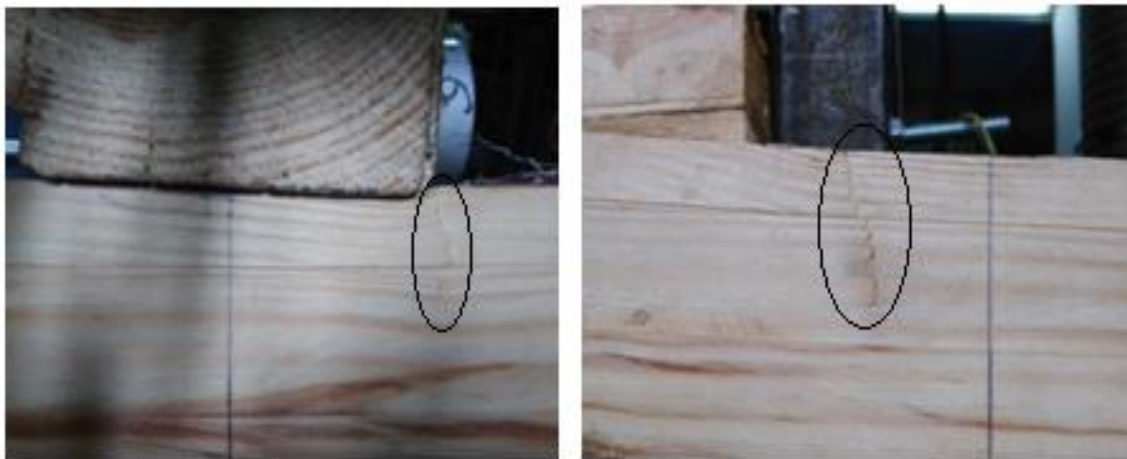
Рис. 5.2 – Утворення складок у стиснутій зоні в елементах з клеєної деревини за роботи на косий згин
