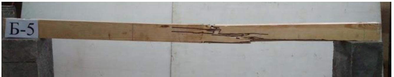
Рис. 5.8 – Характер руйнування балок з суцільної деревини
