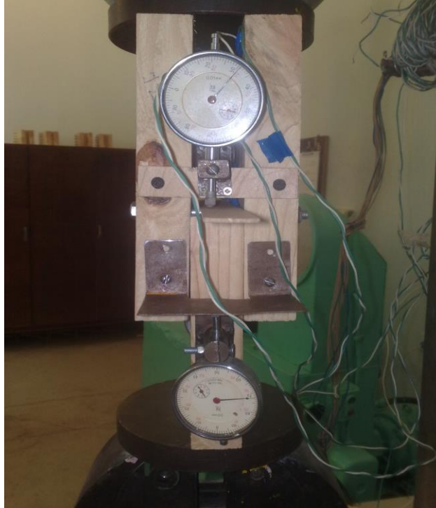
Рис. 2.7 – Болтове з'єднання під навантаженням
