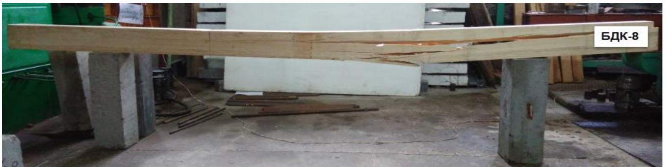
Рис. 5.10. Характер руйнування балок з клеєної деревини за косого поперечного згину
