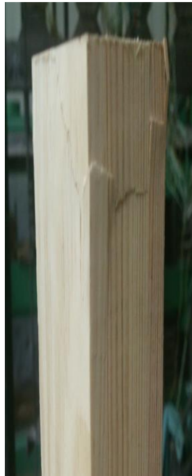
Рис. 2.3 – Найхарактерніші види руйнування призм
