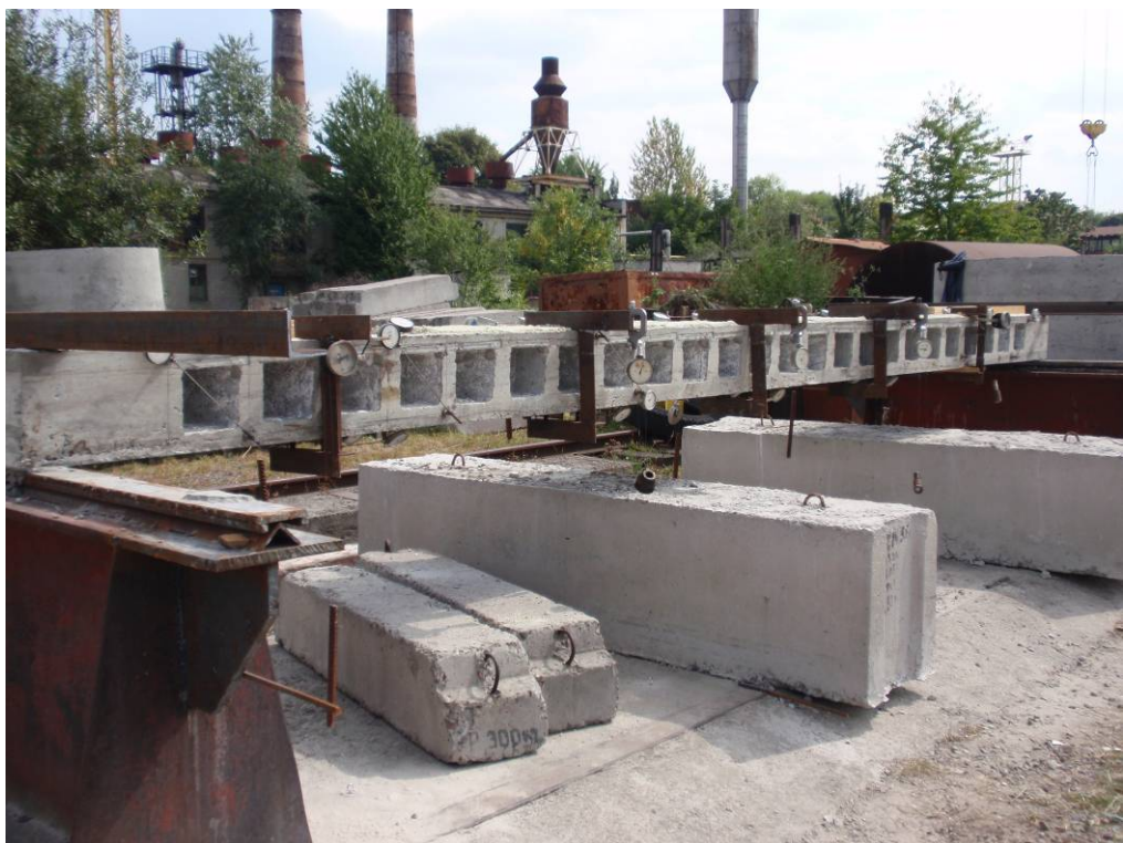
Рис. 2.15. Загальний вигляд підготовлених до випробувань експериментальних зразків плит на згин та розташованими вимірювальними приладами:
