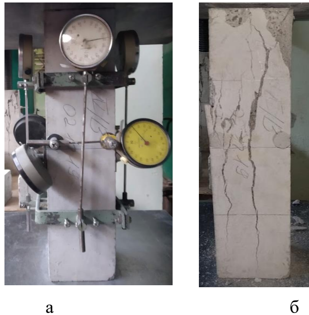
Рис. 4.10 – Визначення показників деформативності самоущільнювального бетону відповідно до ДСТУ Б В.2.7-217:2009 (а) та його зруйнований зразок (б)
