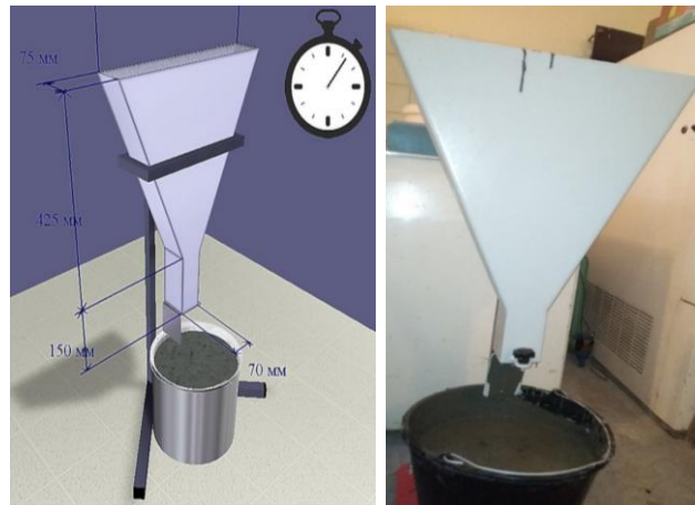
Рисунок 4.7 – Прямокутна воронка для визначення умовної в'язкості самоущільнювальної бетонної сіміші
