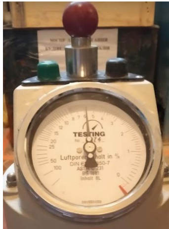
Рисунок 2.14 – Прилад LP-Torf для визначення повітровмісту бетонних і розчинових сумішей у неущільненому стані
