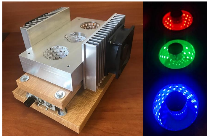
Рис. 3.4. Розроблений радіальний опромінювач, що забезпечує модифікацію просторових параметрів металевих наночастинок під дією LED з довжинами хвиль випромінювання 465, 525 та 623 нм
