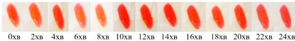
Рис. 4.22. Фотодеградація барвника Родамін 6Ж за допомогою 0,02 г \text{TiO}_2
