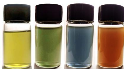
Рис. 3.24. Колоїди срібла до (А) та після опромінювання червоними (В), зеленими (С) та синіми (D) LED
