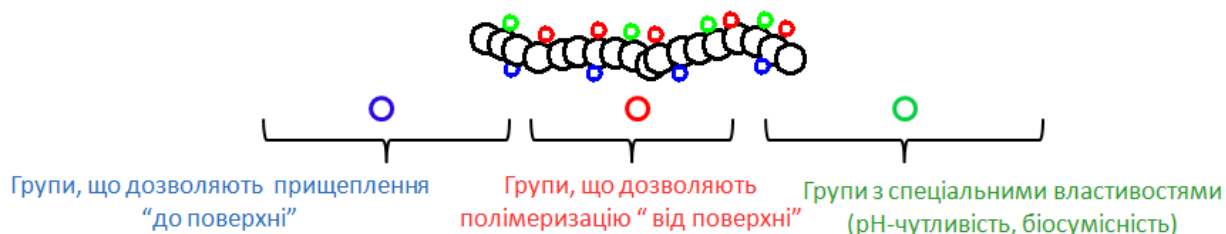
Рис. 3.2. Загальна схема будови МІ прищепленої полімеризації з функціями прищеплення «до поверхні», «від поверхні» та «спеціальними» властивостями.
