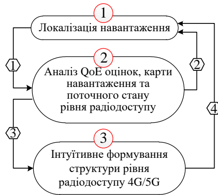
Рис. 5. 19. Загальна блок схема інтенційно-орієнтованого методу розподілу ресурсів та формування структури рівня радіодоступу 4G/5G [221]
