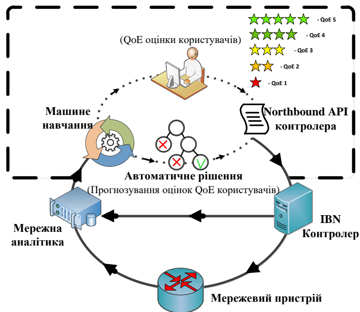
Рис. 3.1. Пропонована концептуальна модель IBN мережі для адаптивного надання сервісів згідно QoE намірів [178]
