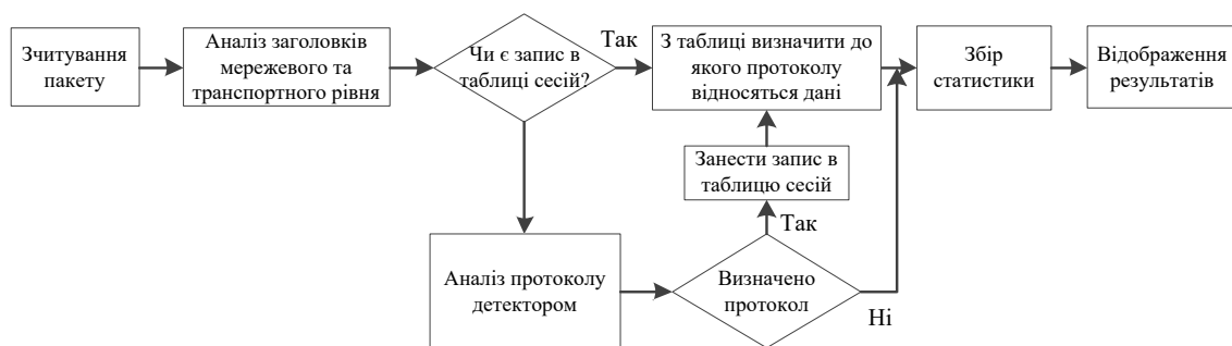
Рис. 4.4. Загальний алгоритм роботи аналізатора трафіку [191]
