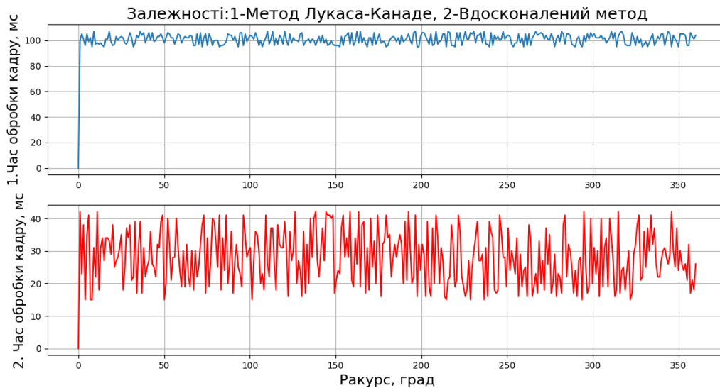
Рис.3. Порівняння швидкості обробки кадру методом Лукаса-Канаде та удосконаленим методом.
