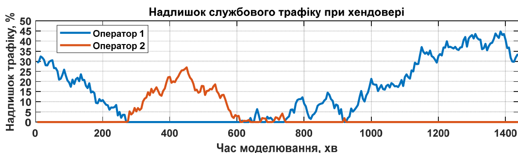
Рис. 5.23. Надлишок використання ресурсів OLT у висхідному напрямку передавання при хендовері абонентів між операторами.
