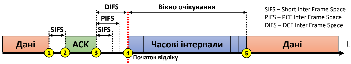
Рис. 4.9. Механізм передавання даних у мережах Wi-Fi.
