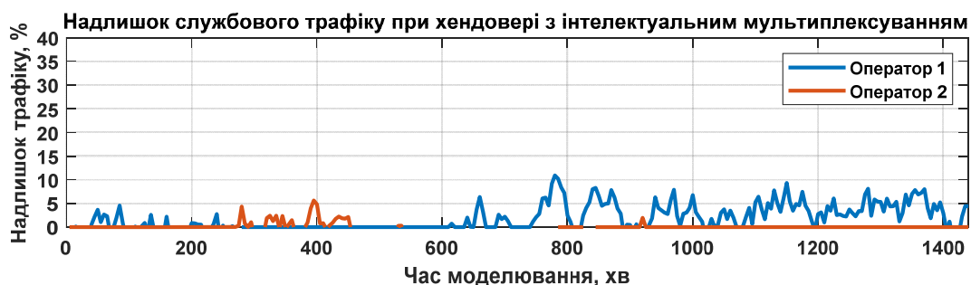
Рис. 5.24. Надлишок використання ресурсів OLT у висхідному напрямку передавання при хендовері абонентів між операторами з використанням запропонованого алгоритму мультиплексування.
