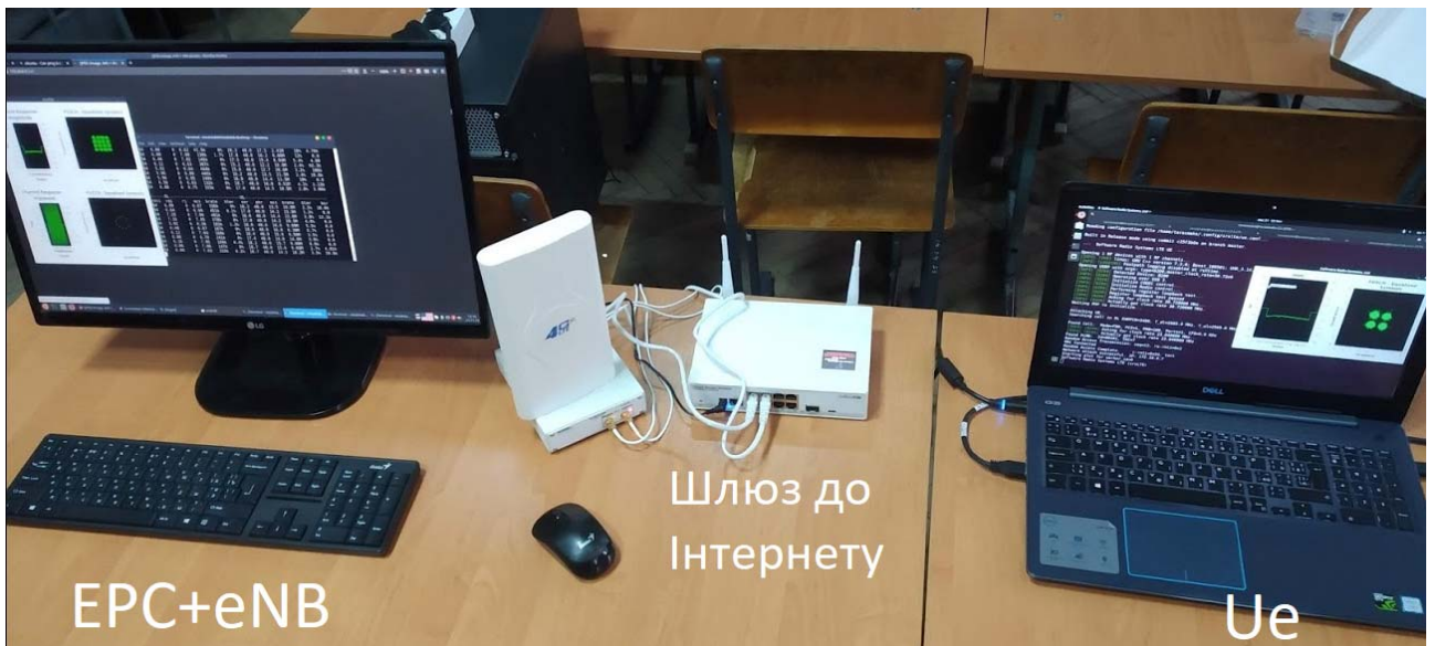
Рис. А.2. Практична реалізація мережі мобільного зв'язку з інтелектуальним автоматизованим управлінням на основі SDR модулів USRP 2900 та віддалених RU.
