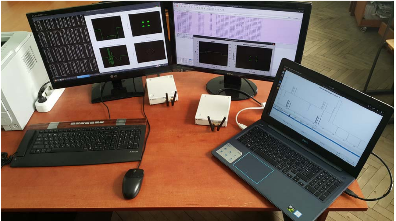
Рис. А.1. Загальний вигляд розробленого макету децентралізованої мережі мобільного зв'язку з використанням SDR модулів USRP 2900.
