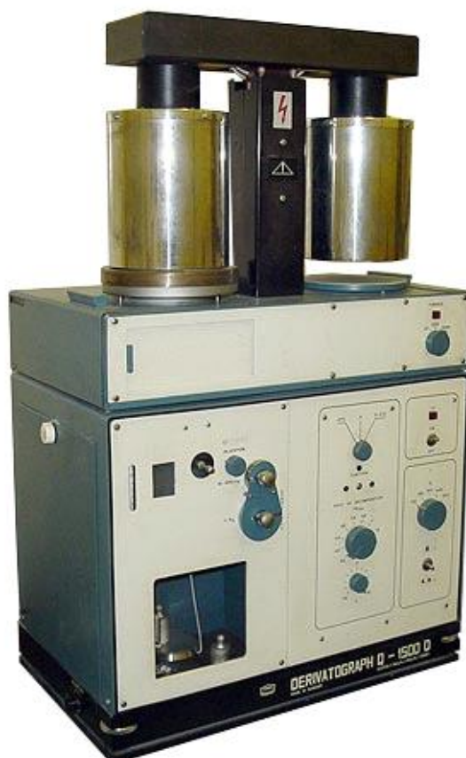
Рис. 3.1. Експериментальна установка (дериватограф) Q-1500 D системи Paulik-Erdey
