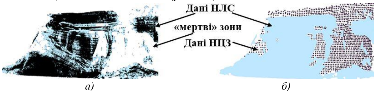
Рис. 13. Реалізація алгоритму виявлення «мертвих» зон НЛС для південної частини льодовика на о. Галіндез (2013 р.): а) з мертвими зонами (до); б) з доповненими точками за даними НЦЗ (після)
