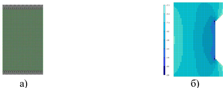
Рис.15. Вилучення скінчених елементів у інструменті «Монтаж»: а) елемент без пошкодження; б) моделювання пошкодження глибиною 2 см.
