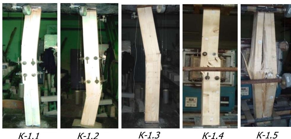
Рис. 5. Вигляд стиснутих дощатоклеєних колон після руйнування:
