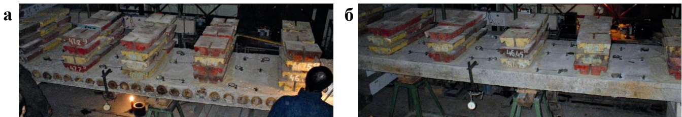
Рис. 2 – Загальний вигляд випробувань: а - плити ФП-1, б - плити ФП-2
