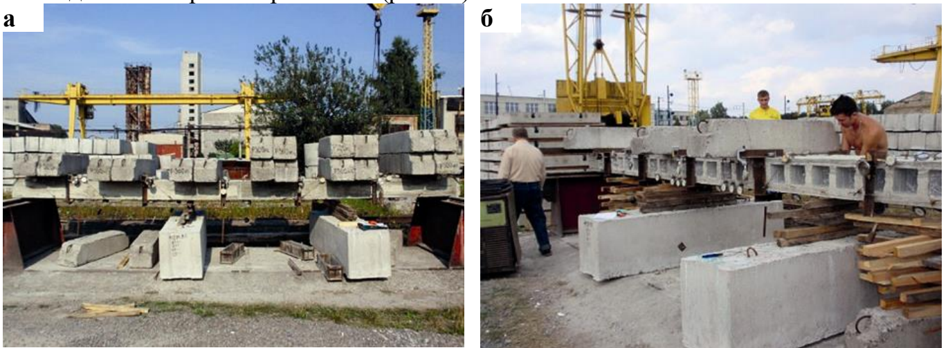
Рис. 11 – Загальні вигляди випробувань плити ПФ-1 (а) і плити ПФ-2 (б)
