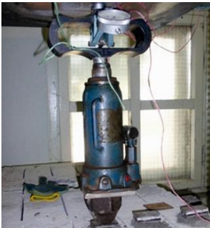
Рис. 17 – Загальний вигляд випробування верхньої полиці на продавлювання
