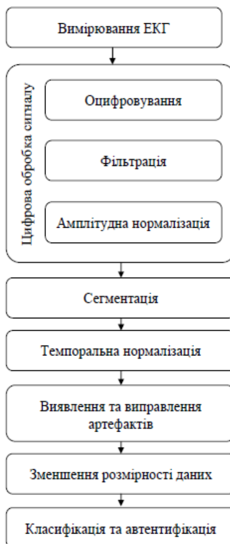
Рис. 2.22. Структурна схема біометричної системи автентифікації із покращеними характеристиками.
