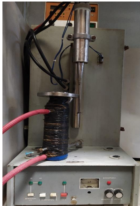
Рис. 2.1. Апарат для проведення уз кавітації у лабораторних умовах
