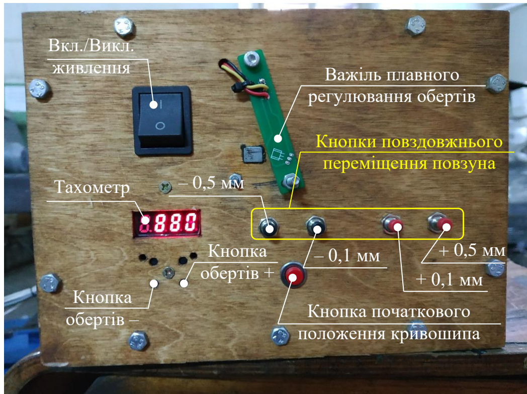
Рис. 5.20. Блок управління керованим кривошипно-шатунним приводом, розроблений на базі Arduino Mega 2650
