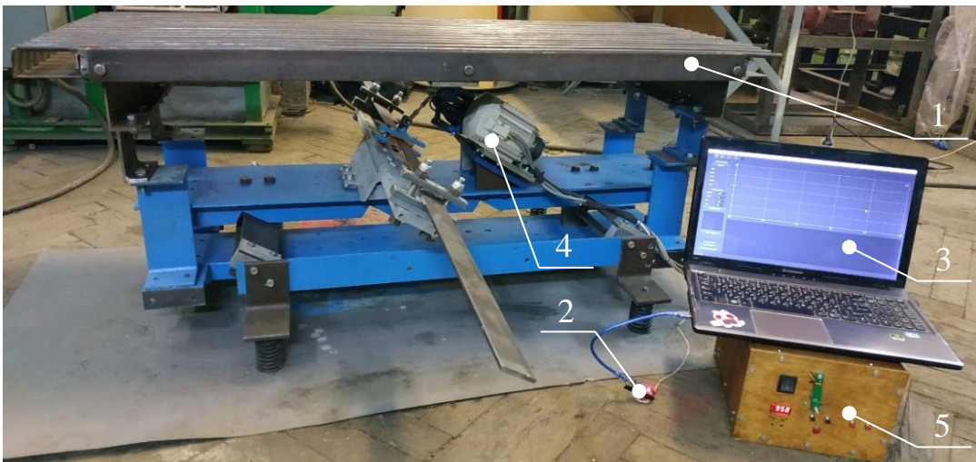
Рис. 5.21. Експериментальний зразок транспортера-сепаратора з під'єднаним лабораторним вимірювальним обладнанням:
