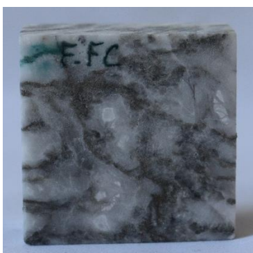
Рис. 4.5.3.4. Зразок, покритий Funcosil FC після циклу змочення і зміни температури
