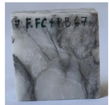
Рис. 4.5.3.15. Зразок, покритий Funcosil FC+Paraloid B67 після циклу змочення і зміни температури
