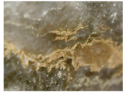
Рис. 4.2.2.3. Мікрофіксація. Збільшення об'єму глинистих домішок. Утворення рельєфної поверхні
