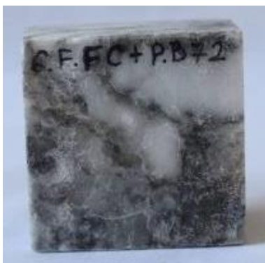
Рис. 4.5.3.13. Зразок, покритий Funcosil FC+Paraloid B72 після циклу змочення і зміни температури
