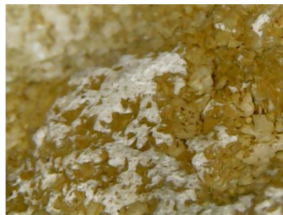
Рис. 4.1.2.8. Наслідок вивітрювання. Стільниця з Львівського історичного музею
