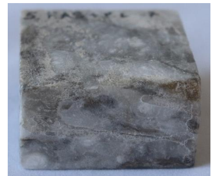
Рис. 4.5.3.12. Формування виступаючих ділянок та утворення плям на зразку, покритому Funcosil AS+Paraloid B67
