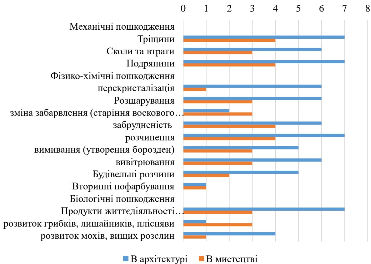
Діаграма 4.1.1.4. Перелік ознак руйнування алебастрових виробів, які розташовані на відкритому просторі без захисту від дії атмосферних опадів
