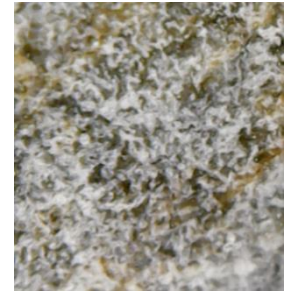
Рис. 4.5.2.16. Мікрофіксація після гідрофобізації і зміцнення
