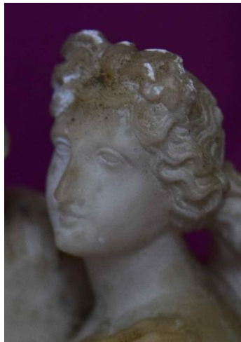
Рис.4.1.1.5. Біологічні ураження, пилові забруднення та процес вивітрювання
