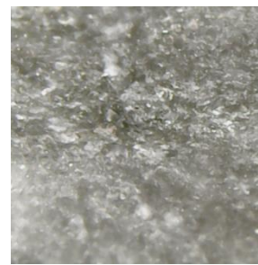
Рис. 4.5.2.4. Мікрофіксація після гідрофобізації Funcosil FC
