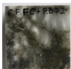
Рис. 4.5.2.11. Зразок, покритий Funcosil FC Paraloid
