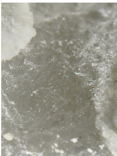
Рис. 4.2.2.23. Процес вимивання кристалічної маси. Утворення борозни
