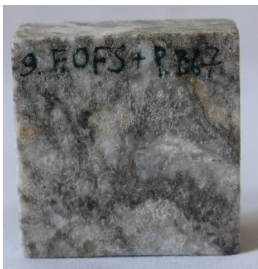
Рис. 4.5.3.19. Зразок, покритий Funcosil OFS+Paraloid B67 після циклу змочення і зміни температури
