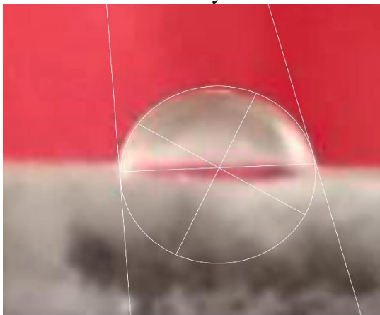
Рис.4.2.1.17. Funcosil OFS, Paraloid B67. Кут змочуваності 82^\circ після циклу змочення/сушіння
