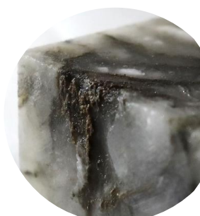
Рис. 4.2.2.22. Розчинення та збільшення об'єму глинистих домішок
