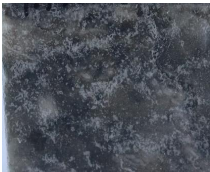
Рис. 4.5.3.10. Формування виступаючих ділянок, покритих розчином Funcosil AS+Paraloid B72
