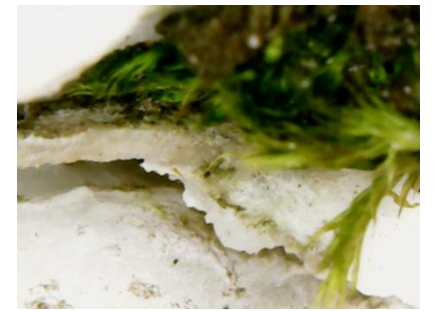
Рис. 4.1.2.18. Мікрофіксація. Розшарування. Органічна складова між шарами кристалічної маси
