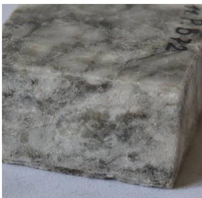
Рис. 4.5.3.22. Утворення білого нальоту на зразку, покритому Paraloid B72
