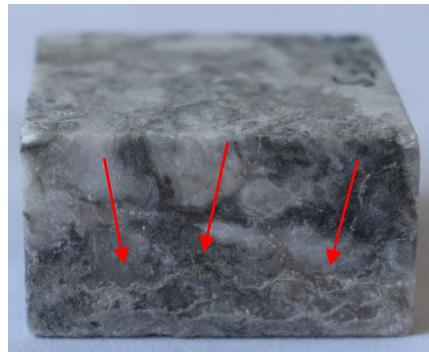
Рис. 4.5.3.8. Виступаючі ділянки покритої нерозчиненої поверхні каменю
