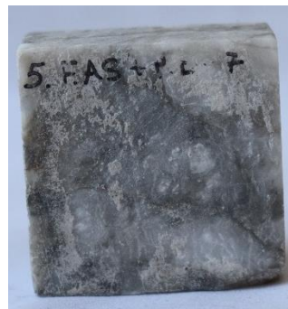
Рис. 4.5.3.11. Зразок, покритий Funcosil AS+Paraloid B67 після циклу змочення і зміни температури
