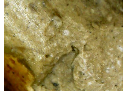
Рис. 4.1.2.3. Забруднення та скруглення кристалічної маси на зразку з сходової клітки Етнографічного музею у Львові
