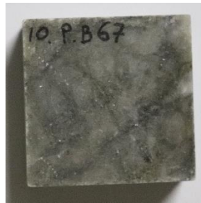
Рис. 4.5.2.19. Зразок, покритий Paraloid B72
