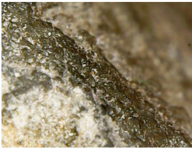
Рис. 4.1.2.4. Атмосферні забруднення алебастру на пробі з віконного обрамленні «Аріанської вежі», м. Белз
