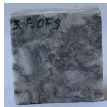
Рис. 4.5.3.6. Зразок, покритий Funcosil OFS після циклу змочення і зміни температури
