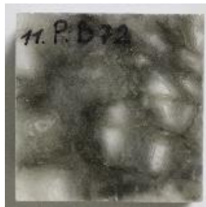
Рис. 4.5.2.21. Зразок, покритий Paraloid B72
