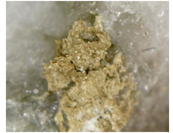
Рис.4.2.2.29. Глинисті прошарки, що виступають над розчиненою кристалічною масою
