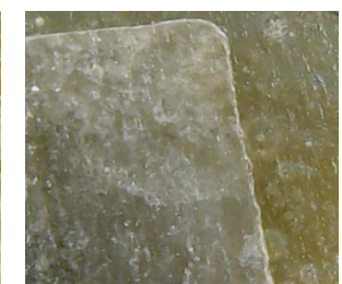
Рис. 4.5.1.50. Відібраний шліф зразка, покритого ваком
