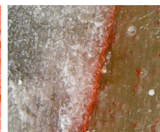
Рис. 4.5.1.52. Відібраний шліф зразка, покритого гуашевою фарбою
