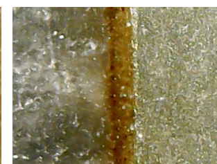
Рис. 4.5.1.56. Відібраний шліф зразка, покритого епоксидним клеєм
