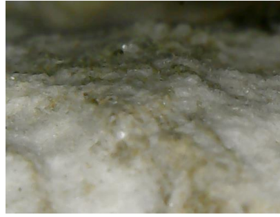
Рис. 4.1.2.11. Наслідок процесу перекристалізації на зразку з фундаменту Чорної кам'яниці, Львів
