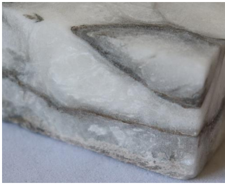
Рис. 4.5.3.16. Утворення виступаючих ділянок внизу торця каменю, покритого Funcosil FC +Paraloid B67
