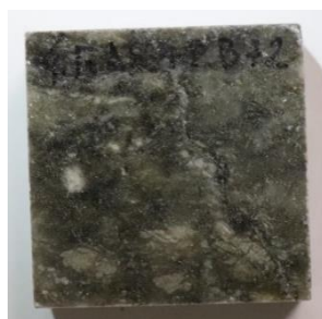
Рис. 4.5.2.7. Зразок, покритий Funcosil AS Paraloid
