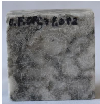
Рис. 4.5.3.17. Зразок, покритий Funcosil OFS+Paraloid B72 після циклу змочення і зміни температури
