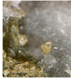
Рис. 4.2.2.28. Нерозчинені глинисті прошарки навколо кристалічної маси
