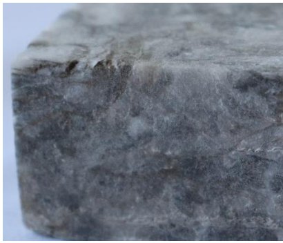
Рис. 4.5.3.7. Утворення тріщини та відрив глинистої складової на зразку, покритому Funcosil OFS
