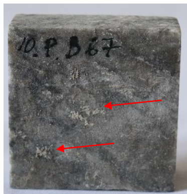
Рис. 4.5.3.20. Зразок, покритий Paraloid B67 після циклу змочення і зміни температури. Виступаючі глинисті домішки
