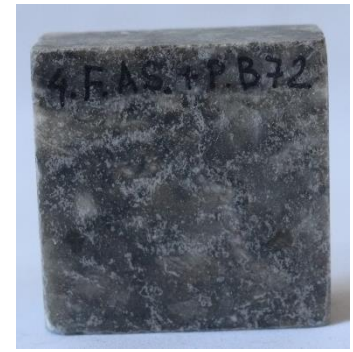
Рис. 4.5.3.9. Зразок, покритий Funcosil AS+Paraloid B72, після циклу змочення і зміни температури
