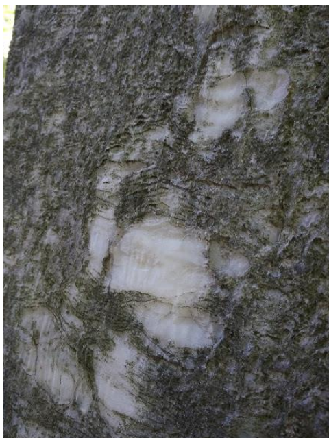
Рис. 4.1.2.24. Розінення та вимивання кристалічної маси, збільшення об'єму глинистої складової
