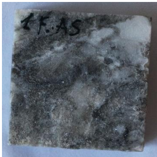
Рис. 4.5.3.1. Зразок покритий Funcosil AS після циклу змочення і зміни температури
