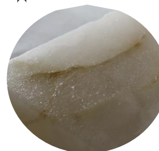
Рис. 4.2.2.19. Розчинення кристалічної маси та виступальні ділянки нерозчинних глинистих мінералів
