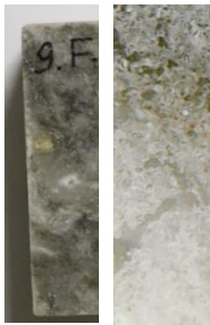
Рис. 4.5.2.17. Зразок, покритий Funcosil Paraloid
