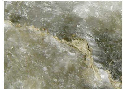
Рис. 4.2.2.5. Мікрофіксація. Відрив глинистих прошарків від кристалічної маси після висихання
