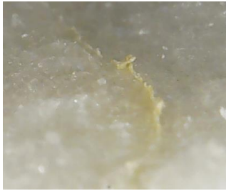
Рис. 4.2.2.26. Глинисті прошарки, що виступають над розчиненою кристалічною масою
