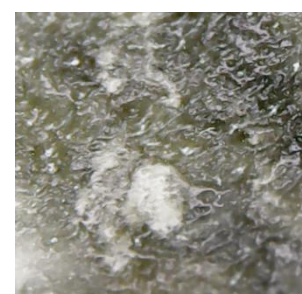
Рис. 4.5.2.12. Мікрофіксація після гідрофобізації і зміцнення Funcosil F
