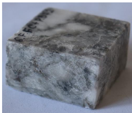
Рис. 4.5.3.14. Утворення плям та виступаючих ділянок на зразку, покритому Funcosil FC+Paraloid B72
