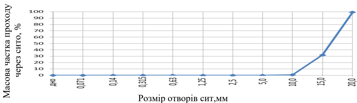
Рисунок 2.5 - Гранулометрична крива щебеню 15-20
