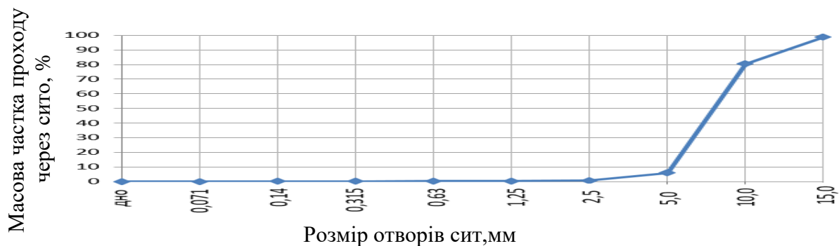
Рисунок 2.7 - Гранулометрична крива щебеню 5-10
