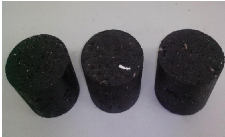
Рисунок 2.15. Зразки асфальтобетону для випробувань
