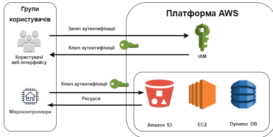
Рис. 4.6. Схема авторизації груп користувачів системи через сервіс AWS Identity & Access Management
