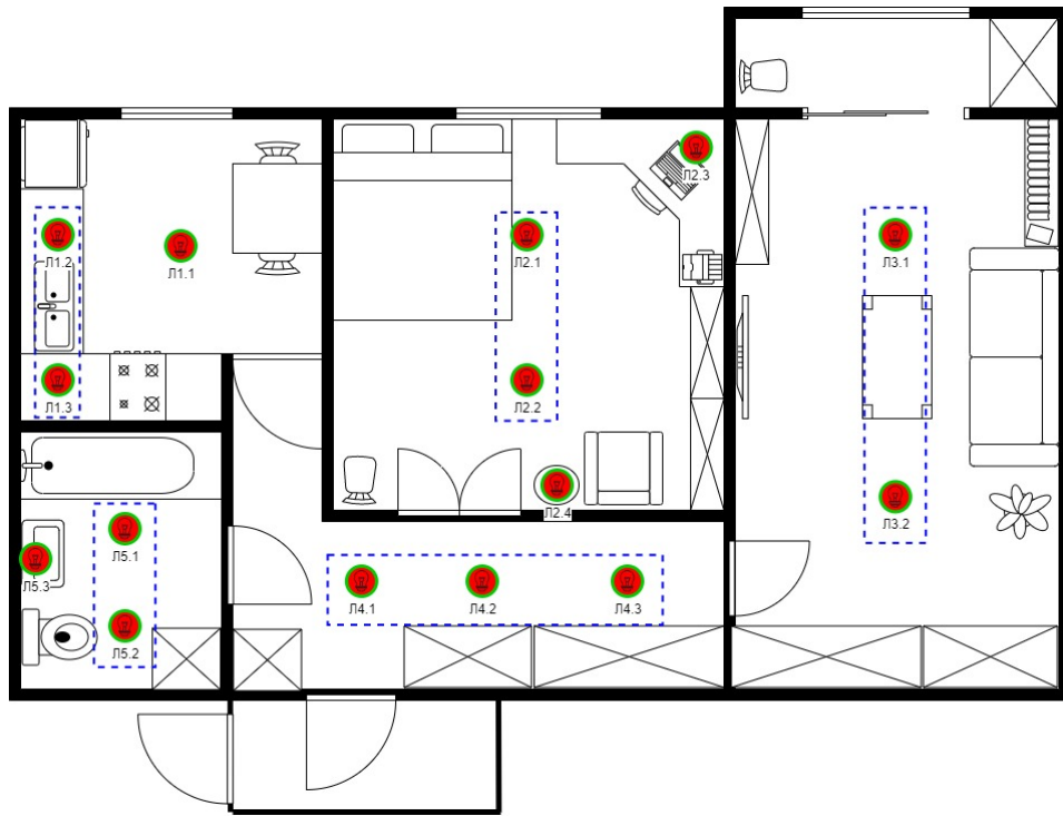
Рис. 3.5. План розташування освітлювальних приладів у помешканні
