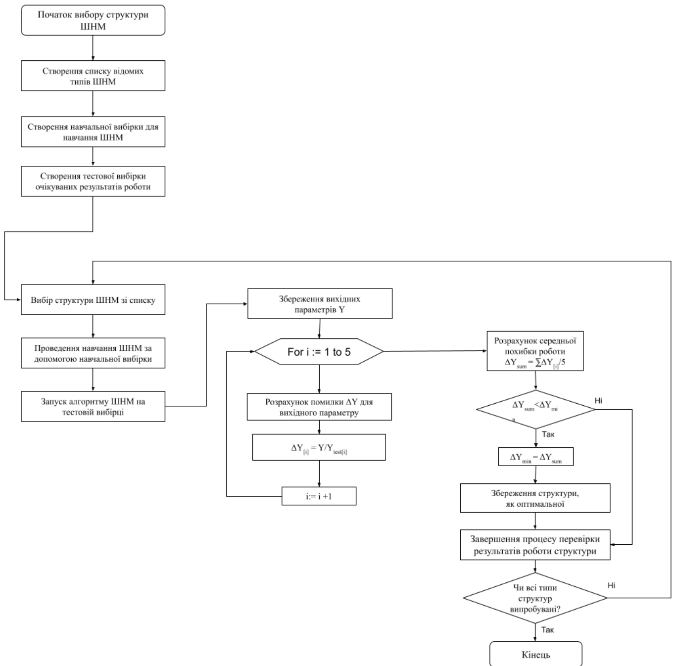
Рис. 2.9. Алгоритм методу вибору оптимального типу нейронної мережі
