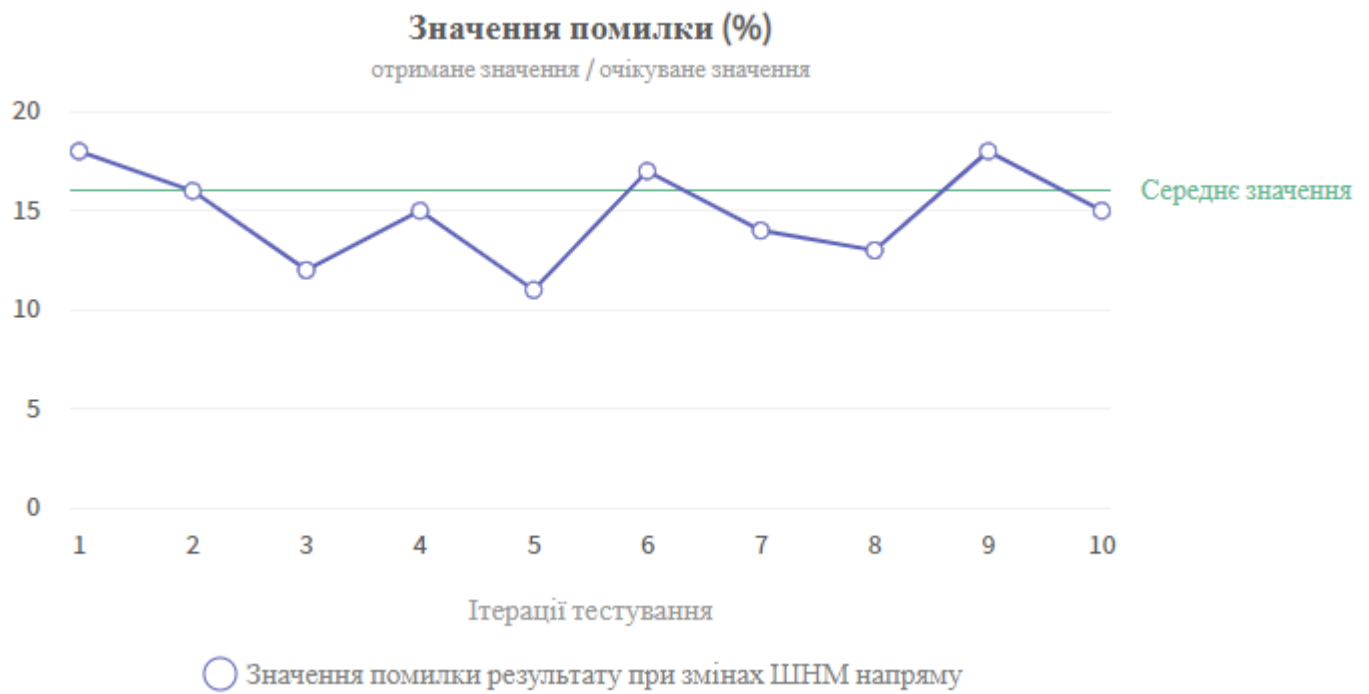
Рис. 4.26. Значення похибок роботи системи при зміні налаштувань ШНМ напряму
