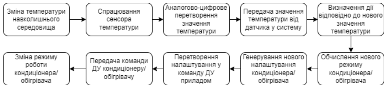
Рис. 2.7. Схема трансформації даних
