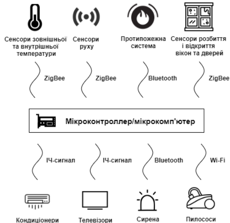
Рис. 4.2. Схема протоколів комунікації сенсорів та побутових приладів з контроллерами клієнтської частини
