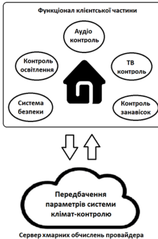
Рис. 2.2. Схема розподілу локальних функцій та функцій у хмарі
