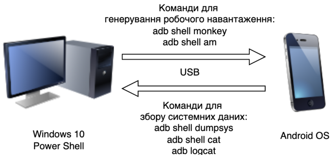
Рис. 4.2. Програмно-апаратне середовище виконання стресових тестів
