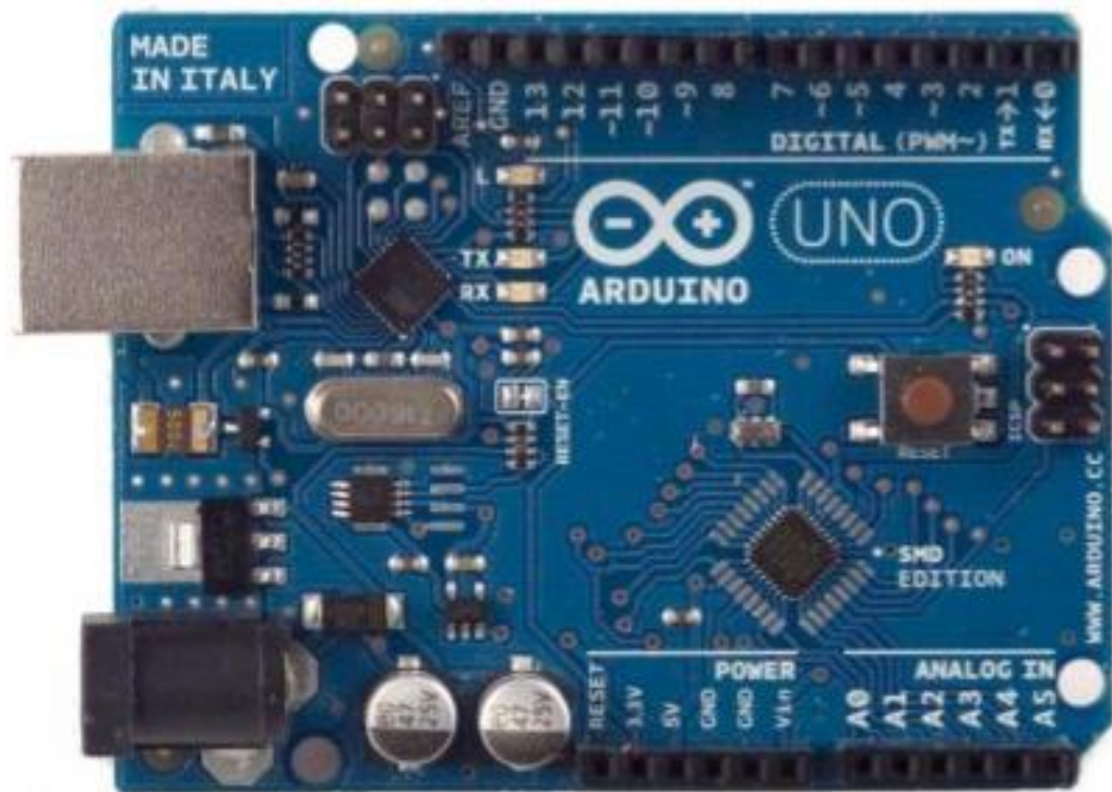
Рис.3.2. Плата Arduino UNO з мікроконтролером ATmega328
