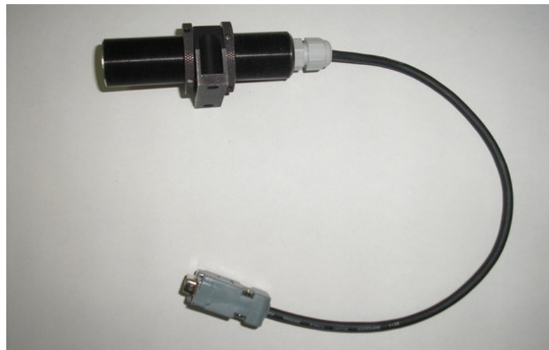
Рис. 1.5. Сенсор індукції магнітного поля SG747
