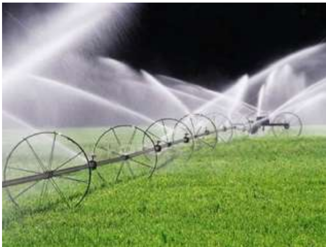
Рис. 1.2. Дощувальна машина “Волжанка” (світлину взято з сайту: https://webferma.com/rastenievodstvo/sistemi-orosheniya/volzhanka.html )
