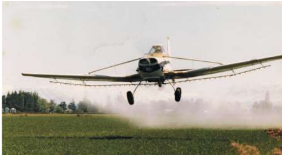
Рис. 1.10. Розподільні трубопроводи в сільськогосподарській авіації (Cessna 188 AG Wagon, Нова Зеландія; світлина взято з сайту: https://commons.wikimedia.org/wiki/File:Cessna188AGWagonZKCSE.jpg )
