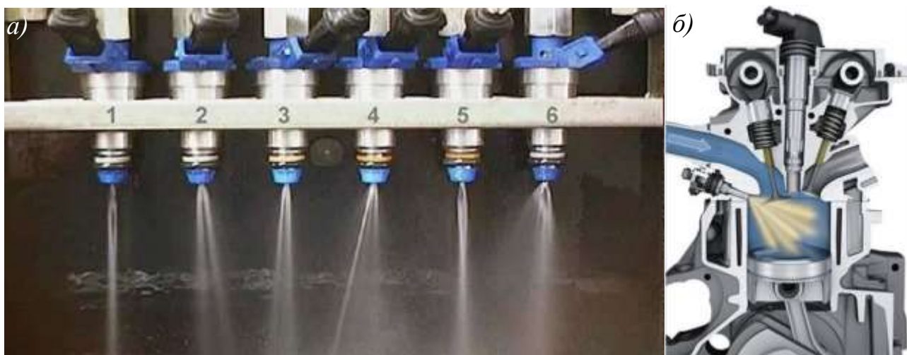
Рис. 1.12. Паливні системи двигунів внутрішнього згорання: а – випробовування розподільної магістралі бензинового двигуна; б – впорскування пального в циліндр дизельного двигуна [3, с. 253]
