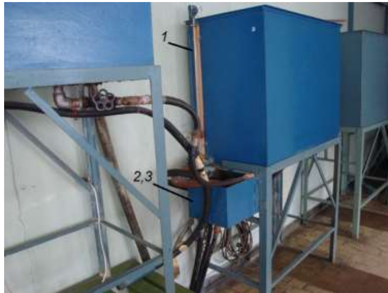
Рис. 3.13. Баки з водою (на рівні дна центрального бака 1 закріплено напірний бачок 2 та скидний бачок 3, розміщені в одному корпусі та розділені переливною стінкою)
