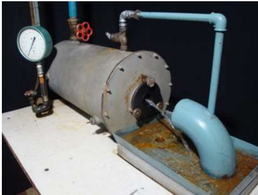
Рис. 3.2. Витікання води крізь вихідну насадку, закріплену у фрагменті РТ, змонтованому на внутрішній стінці торцевої кришки напірного бака
