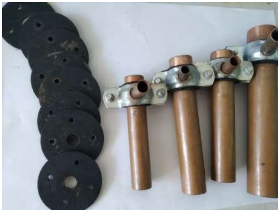
Рис. 3.9. Виготовлені фрагменти РТ з досліджуваними насадками та шайбами для кріплення насадок на торцевій кришці напірного бака
