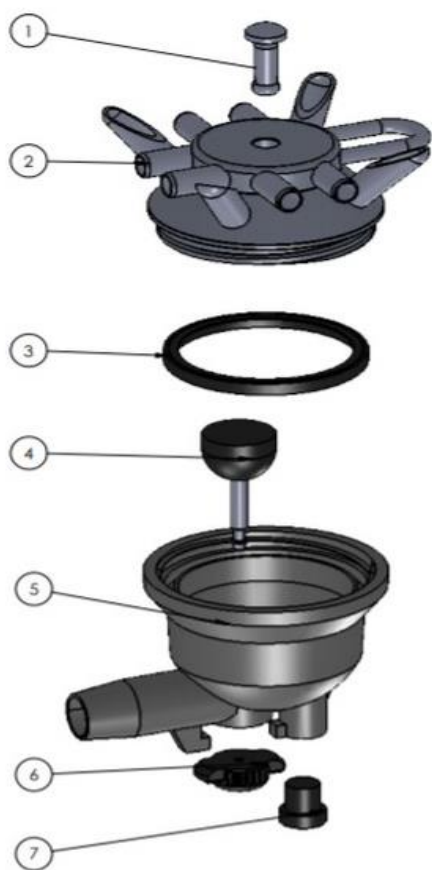
Рис. 1.9 [2]- колектор фірми DeLaval модель «Style Standart Flo-View Claw»:
