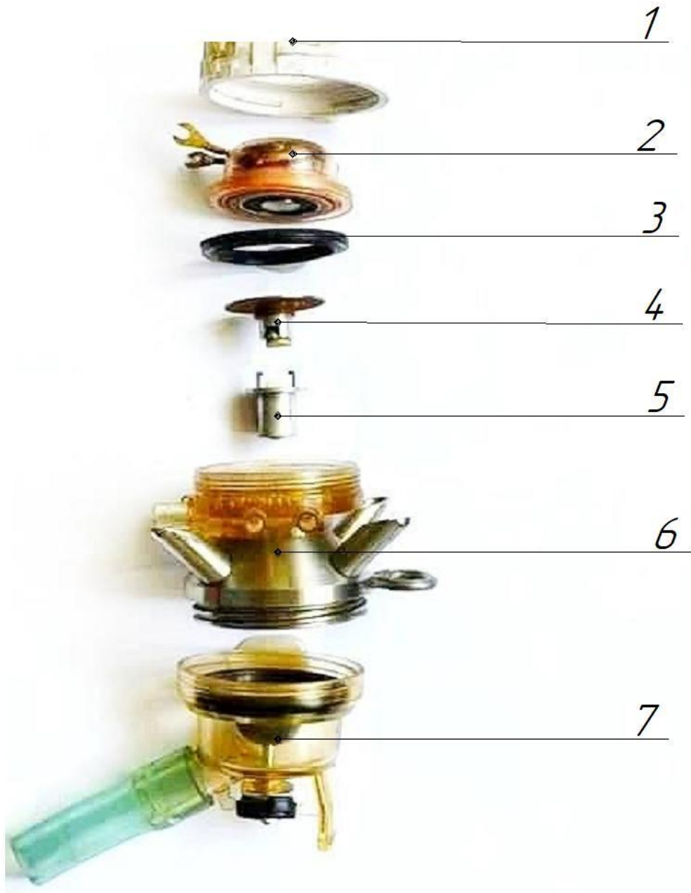
Рис. 3.2 – Будова пневмоелектромагнітного пульсоколектора:
