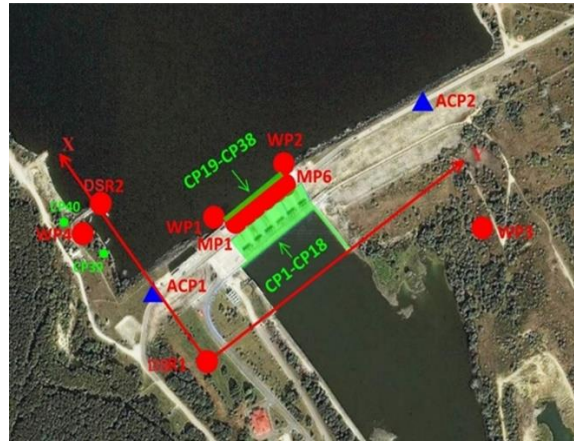
Рисунок 3.13 – Мережа геодезичних пунктів ССМПЗС Дністровської ГЕС-1
