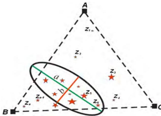
Рисунок 1.3. Трикутник мережі ABC, у якому відбулися землетруси Z_1 \dots Z_n , a та b відповідно велика та мала осі еліпса розсіювання землетрусів [24]
