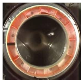
Рисунок 3.21 – Фотоілюстрація якісного стану руху робочої рідини в камері автобалансира з перегородками
