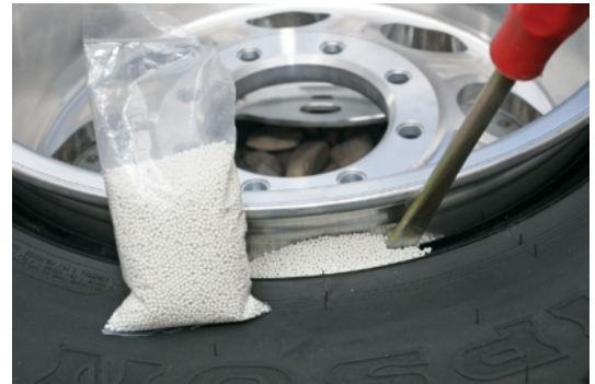
Рисунок 1.8 – Ілюстрація до технології Autobalance для автомобільних коліс Magnum
