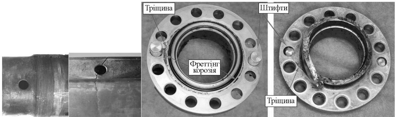
Рис. 1.8. Приклади руйнування деталей внаслідок появи тріщин втомі [10,11]
