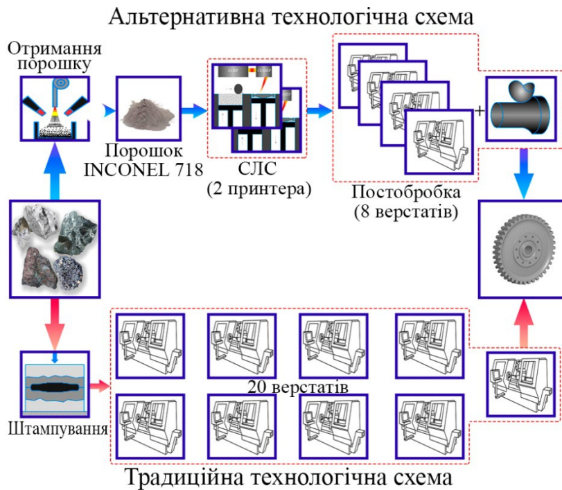
Рис.5.3. Порівняння традиційної та альтернативної технологій отримання диска ГТД літального апарату
