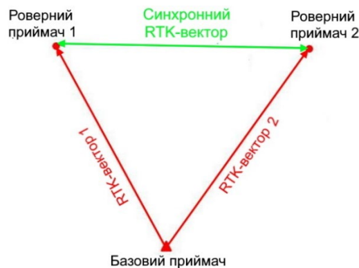
Рис. 2.11. Синхронний принцип визначення RTK- вектора
