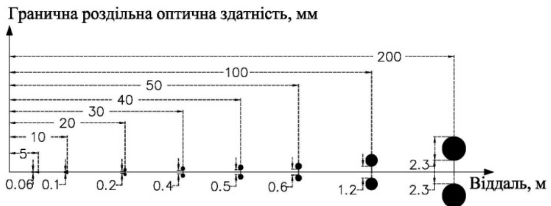
Рис. 3.15. Гранична лінійна роздільна здатність на різних віддальх для зорової труби із збільшенням 30*
