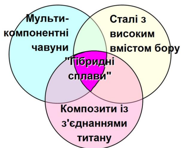
Рис. 6.9. Схема концепції розробки гібридних зносостійких сплавів
