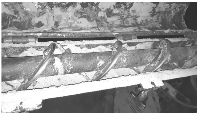
Рис. 7.3. Змішувач для виготовлення холодних твердіючих сумішей ливарних форм
