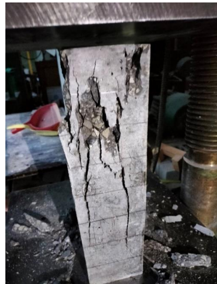
Рисунок 4.16 – Випробування бетонів на основі ЗРБ: а – визначення модуля пружності; б – визначення призмovoї міцності
