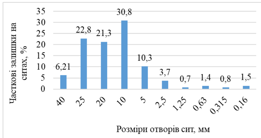
Рисунок 3.3 – Часткові залишки подрібнених відходів бетону
