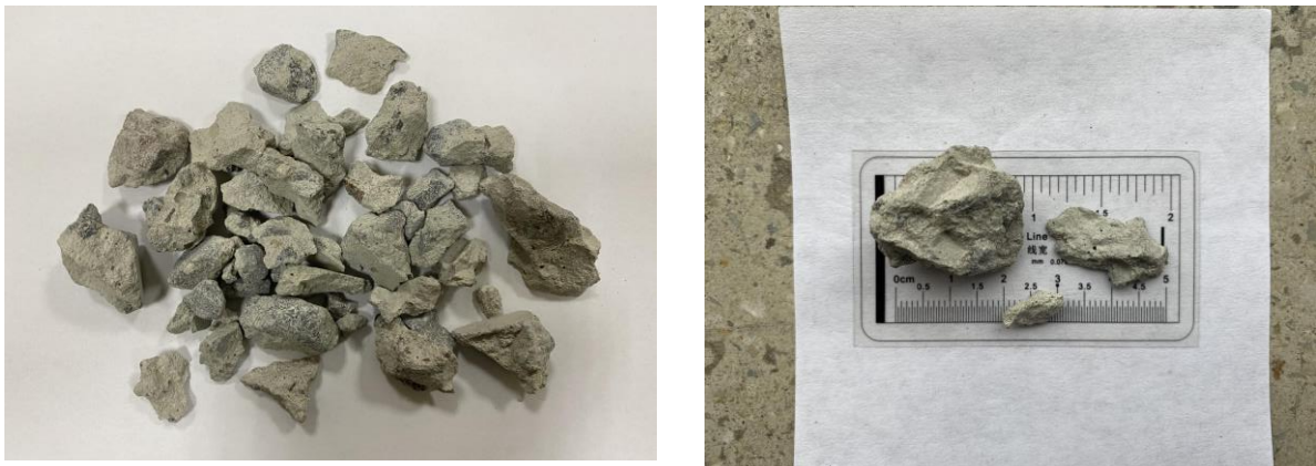
Рисунок 3.4 - Зерна відходів рециклінгу бетону
