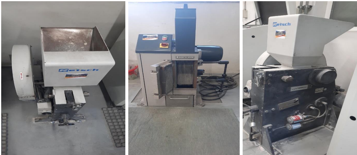
Рисунок 2.9 – Щоккова дробарка для подрібнення відходів бетону
