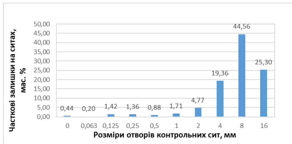
Рисунок 3.5 – Діаграми часткових залишків заповнювачів рециклінгу бетону з використанням стандартних сит згідно з ДСТУ Б В.2.7-71-98 (а) та ДСТУ EN 933-7:2021 (б)
