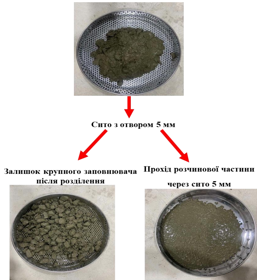
Рисунок 4.8 – Бетонна суміш на основі поліфракційних заповнювачів, розділена через сито отвором 5 мм: а – бетонна суміш до розділення; б – залишок крупного заповнювача після розділення; в – цементно-піщаний розчин, що пройшов крізь сито з отвором 5 мм
