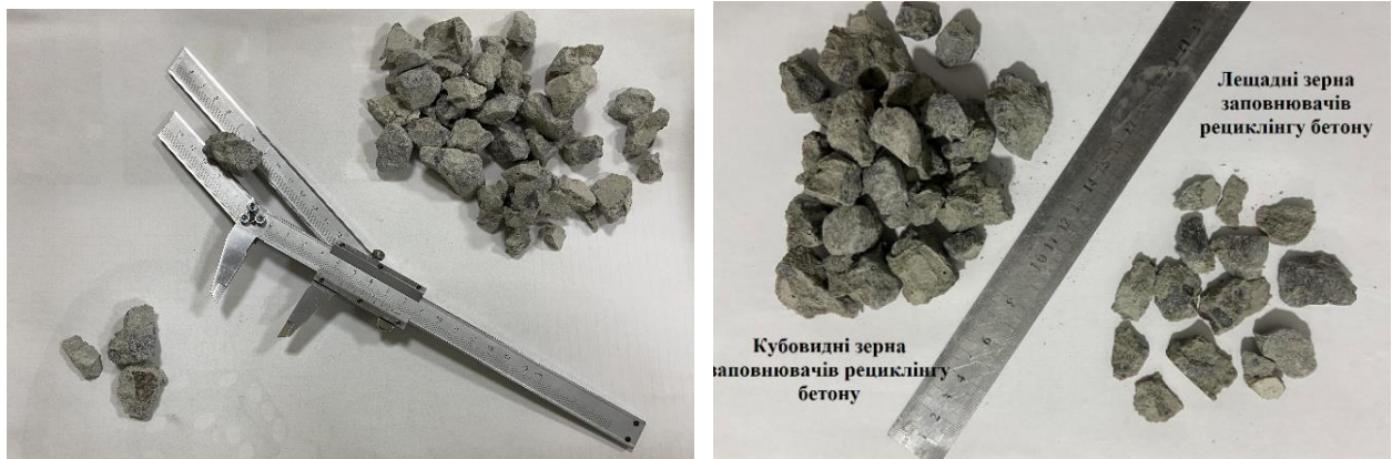
Рисунок 3.6 – Визначення зерен пластинчатої, лещадної та голчатої форми заповнювачів рециклінгу бетону
