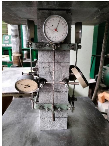
Рисунок 4.16 – Випробування бетонів на основі ЗРБ: а – визначення модуля пружності; б – визначення призмovoї міцності
