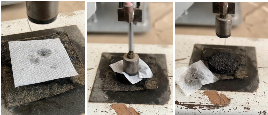
Рис. 4.5 Використання фільтрувального паперу для запобігання високої липкості зразків ЛЕМС
