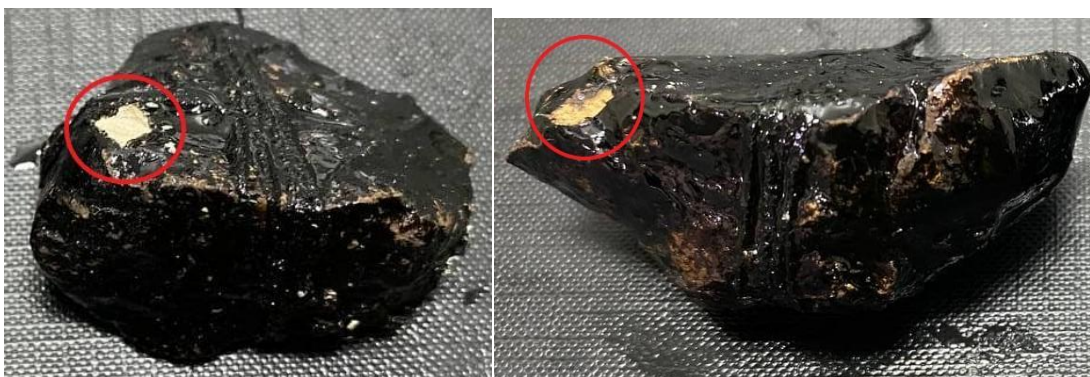
Рис.4.19 Викришування частинок породи вапнякового щебню
