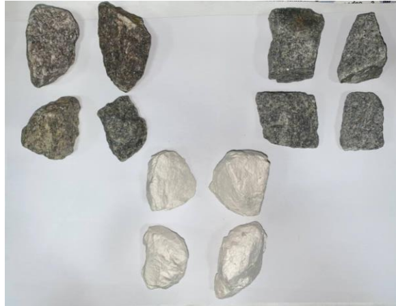
Рис.2.17 Підготовлені гранітні та вапнякові щебні для випробування за методикою №1 та №2
