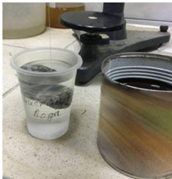
Рис.2.18 Занурення щебінки в ємність з дистильованою водою
