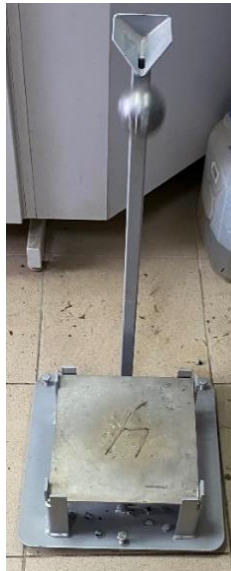
Рис. 4.24 Процеси визначення механічної адгезії методом Vialit: а) розподілення щебня; б) ущільнення зразка; в) випробування зразка; г) визначення кількості неприживлених щебінок
