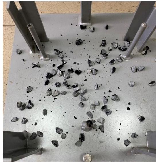
Рис. 4.24 Процеси визначення механічної адгезії методом Vialit: а) розподілення щебня; б) ущільнення зразка; в) випробування зразка; г) визначення кількості неприживлених щебінок
