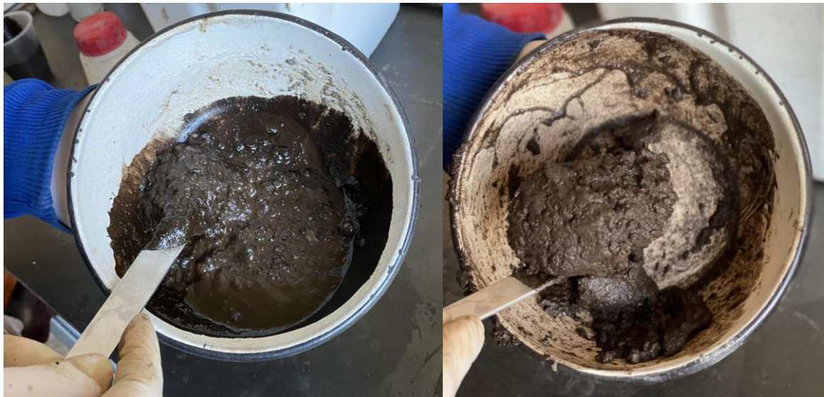
Рис. 2.13 Визначення часу розпаду ЛЕМС: а) перемішування суміші; б) втрата рухливості суміші
