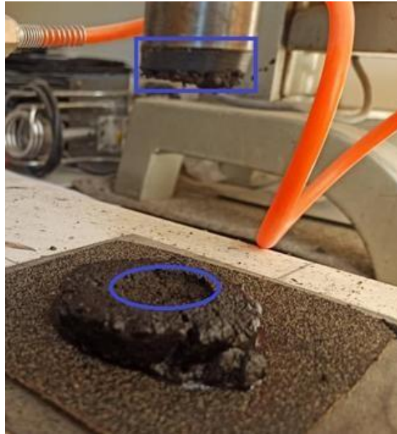
Рис. 4.4 Прилипання окремих частин зразку ЛЕМС до гумового наконечника за визначення когезійної міцності
