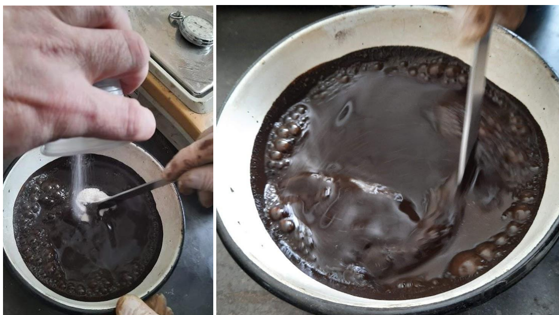
Рис. 2.11 Змішуваність розчину емульсії з мінеральним наповнювачем
