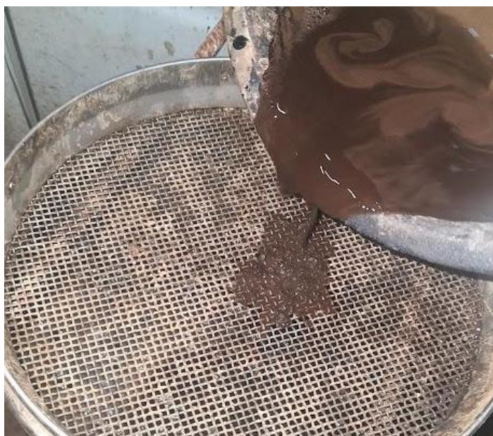
Рис. 2.12 Проходження емульсії з портландцементом крізь сито 2 мм
