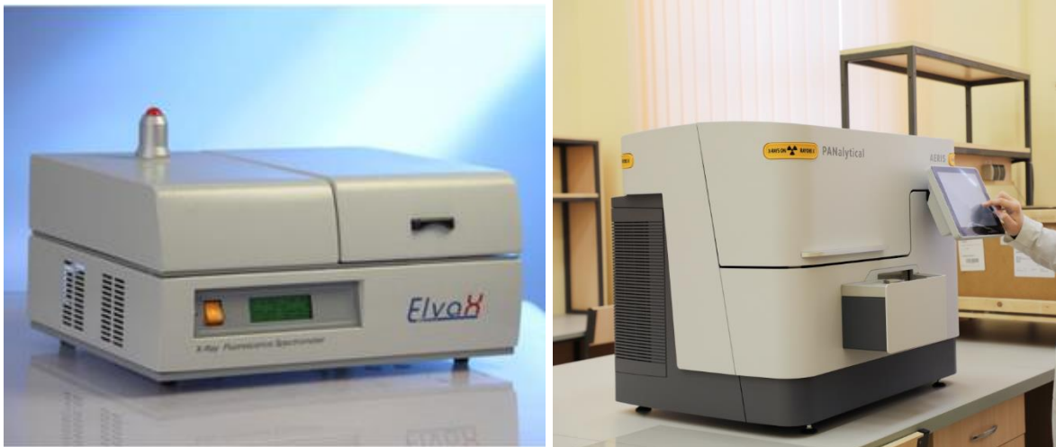
Рис. 2.4 Прилади для визначення елементного та мінералогічного складу кам'яних матеріалів: а) рентгенфлуоресцентний аналізатор ElvaX Light SDD; б) рентгенівський дифрактометр AERIS Research.
