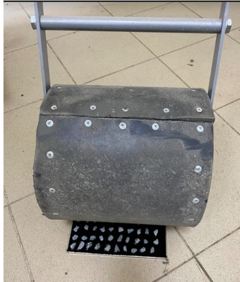
Рис.2.22 Ущільнення щебню на пластині Vialit спеціальним катком
