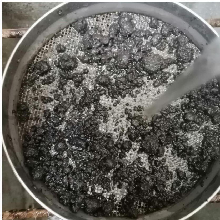
Рис 3.8 Залишок на ситі БЕ на ортофосфорній кислоті після змішування з портландцементом
