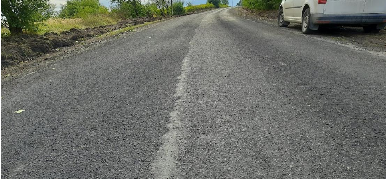
Рис. 5.1 Перша пробна ділянка влаштування ЛЕМС на ортофосфорній кислоті в Україні (смуга руху ліворуч – традиційна ЛЕМС на дистиляційному бітумі з важкої нафти і соляній кислоті, смуга руху праворуч – на окисненому бітумі із легкої нафти і ортофосфорній кислоті)
