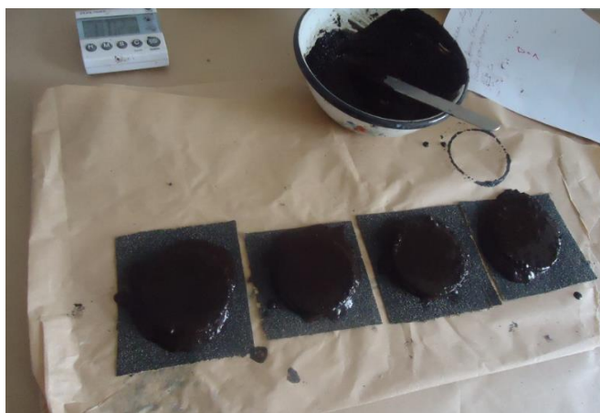
Рис. 4.3 Заформовані зразки для визначення когезійної міцності ЛЕМС
