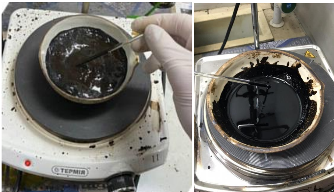
Рис. 2.8 Процес випаровування води з емульсії методом за ДСТУ Б В.2.7-129:2013 [7]
