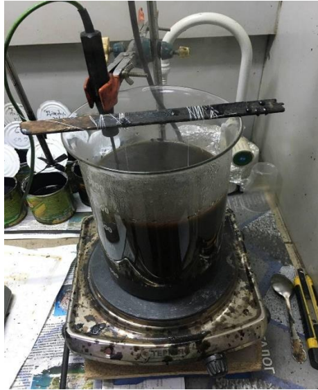
Рис.4.20 Кип'ятіння вапнякового щебню в дистильованій воді
