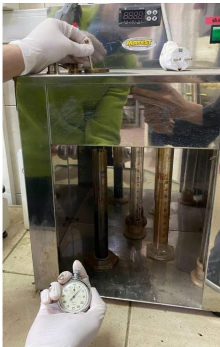
Рис. 2.9 Визначення умовної в'язкості емульсії віскозиметром «Matest»
