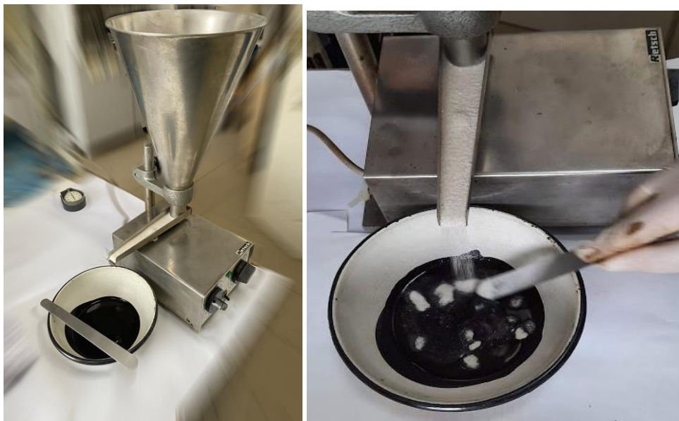
Рис. 2.10 Дозування наповнювача дозатором Retsch DR
