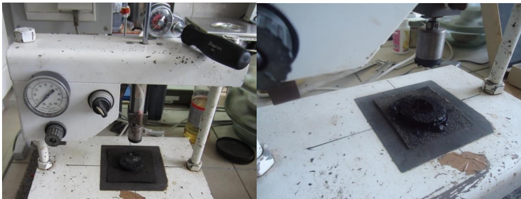
Рис. 2.14 Прилад для визначення когезійної міцності із дослідженням зразком ЛЕМС
