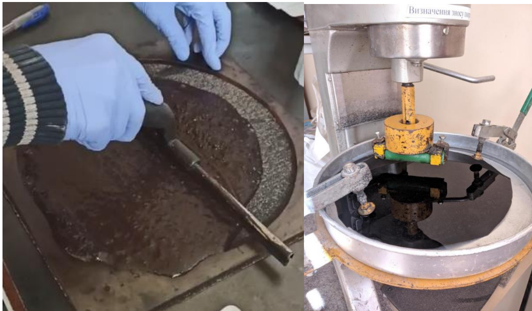
Рис.2.16 Вигляд перед випробуванням ЛЕМС за ВМВЗ: а) формування зразку; б) зразок перед випробування у водному середовищі
