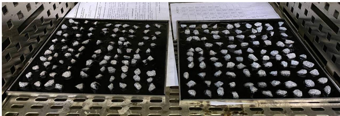
Рис.4.21 Загальний вигляд зразків ПО у сушильній шафі з примусовою вентиляцією
