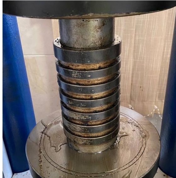
Рис. 4.27 Виділення води за ущільнення зразка СХР
