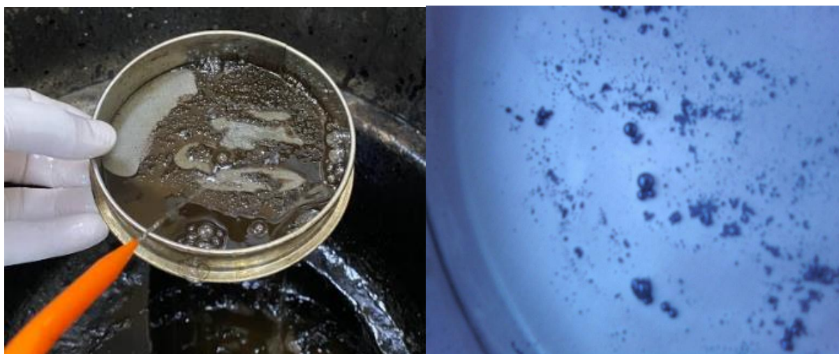
Рис. 2.7 Встановлення однорідності БЕ: а) промивання БЕ; б) оцінка крупності та однорідності краплинок бітуму в БЕ
