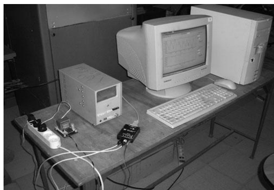
Рисунок 2.5 - Загальний вигляд (а) та схема вимірювальної частини (б) установки для визначення характеристик тріщиностійкості:
