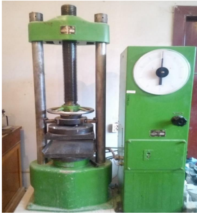
Рисунок 2.2. Гідравлічний прес П-50 для визначення міцності на стиск
