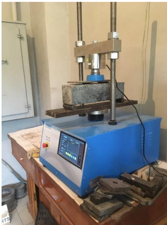
Рисунок 2.3. Визначення міцності бетону на розтяг при згині на пресі УТМ-0108
