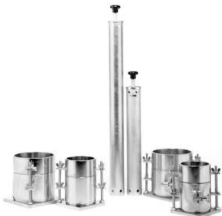
Рисунок 2.6 Комплект обладнання для визначення максимальної щільності скелета ґрунту при оптимальній вологості за методом Проктора
