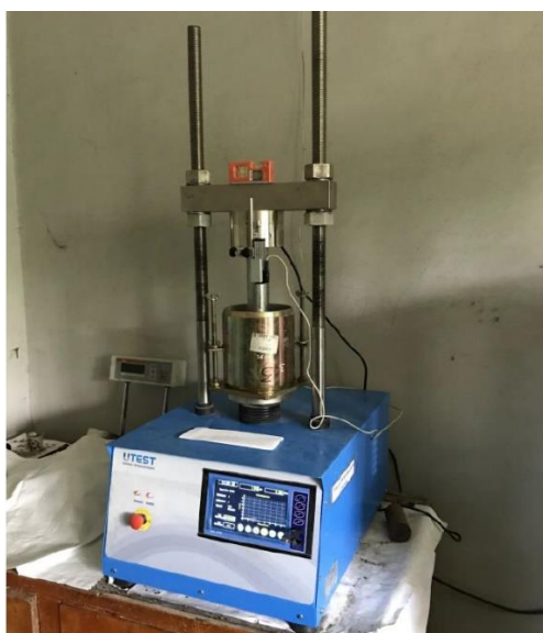
Рисунок 2.7 Визначення каліфорнійського коефіцієнта несучої здатності ґрунту (CBR)
