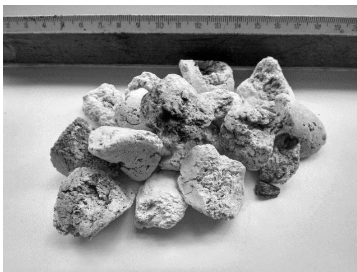
Рисунок 2.8 Загальний вигляд термоактивованих відходів від спалювання макулатурного скопу
