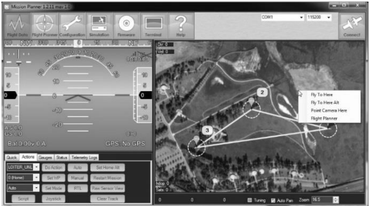
Рис. 5.11. Отримання телеметричних даних програмою Mission Planner, фіксованих проєктованим орнітоптером
