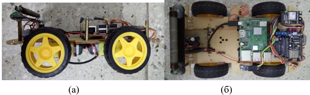
Рис. 5.7. Зібрана мобільна платформа, вид збоку (а) , вид зверху (б).
