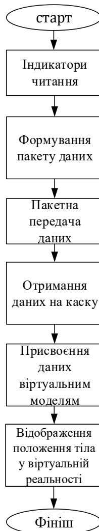
Рис. 5.2. Граф-схема однієї ітерації алгоритму для визначення положення тіла людини
