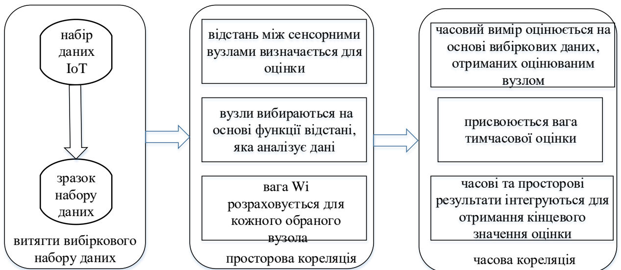
Рис. 1.8. Робочий процес алгоритму тимчасової та просторової кореляції
