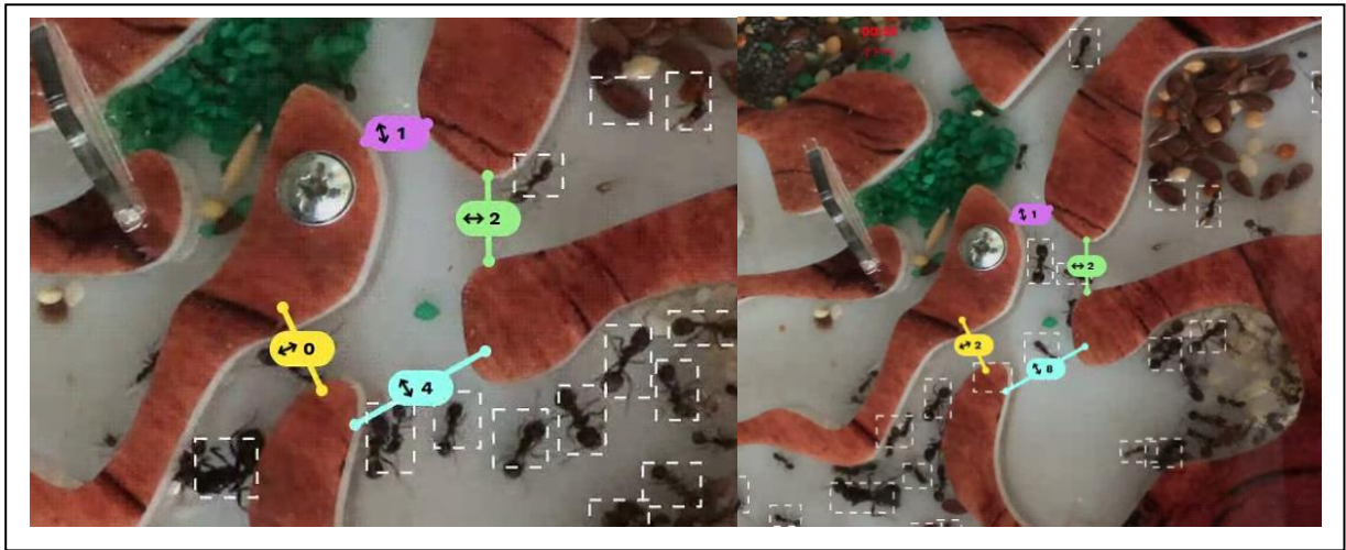
Рис. 4.17. Розпізнавання та рахування руху класу об'єктів у різні регіони формікарія. Зліва – з використанням Угорського алгоритму збіжності. Справа – з використанням алгоритму збіжності Kd-tree. Параметр ВАТ був визначений як 45 для обидвох випадків.
