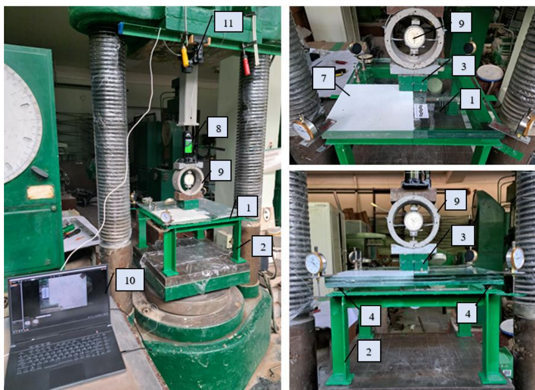
Рис. 2.8. Загальний вигляд випробувальної установки скляних плит на згин, де: 1 – скляна плита, 2 – металева опорна рамка, 3 – штамп, 4 – шарнірні опори, 7 – зона фотофіксації КЦЗ, 8 – гідравлічний домкрат, 9 – кільцевий динамометр, 10 – ПК, 11 - фотокамера.
