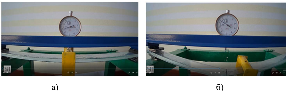
Рис.2.6 Зображення з відеокамери YI Dome Camera 360°: а) в процесі випробування, б) після руйнування дослідного зразка
