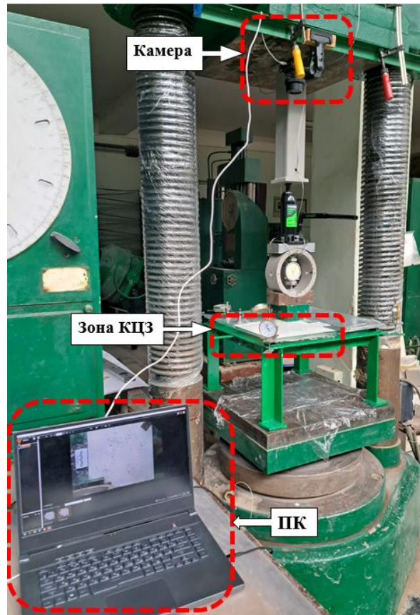
Рис. 2.13 Установа для вимірювання деформацій методом КЦЗ
