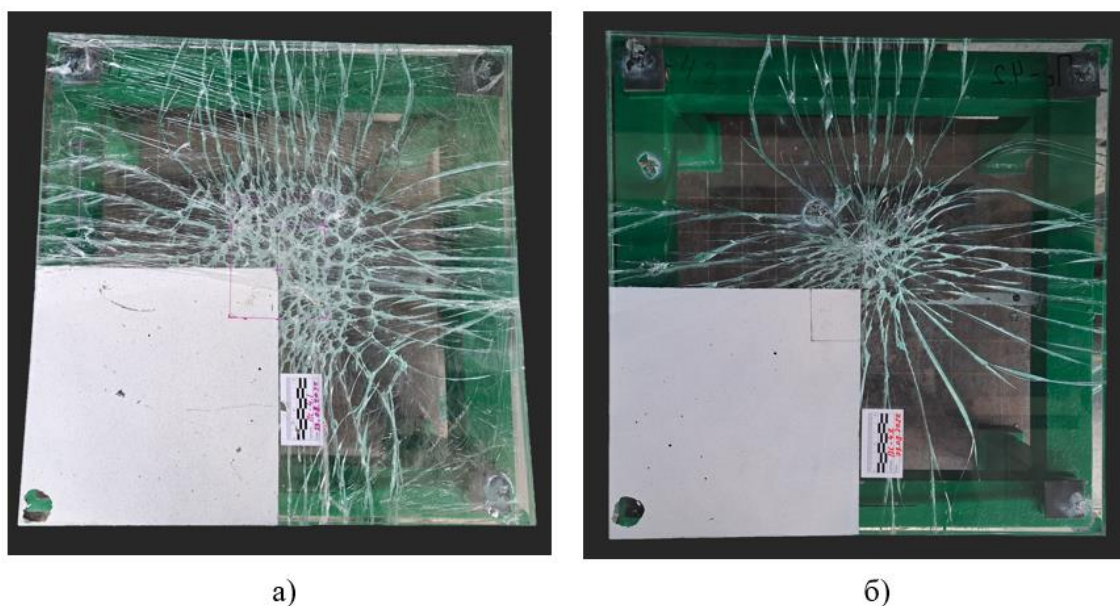
Рис. 3.11 Вигляд скляних плит після руйнування: а) плита марки ПС-4.1; б) плита марки ПС-4.2
