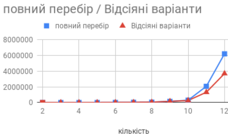
Рис. 4.4. Графік залежності варіантів поєднання елементів: синій – загальна кількість варіантів; червоний – кількість варіантів відсіяних фільтром сумісності за портами
