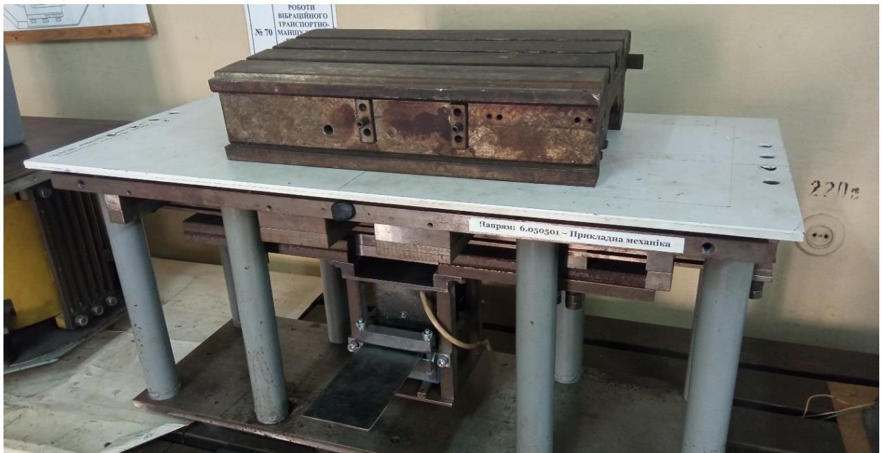
Рис. 5.8. Експериментальний зразок дискретно-континуального міжрезонансного вібраційного столу з наважкою масою 40 кг
