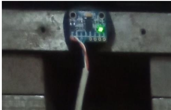
Рис. 5.2. Під'єднання датчика акселерометра/гіроскопа MPU-6050 до активної маси під час знімання коливань системи
