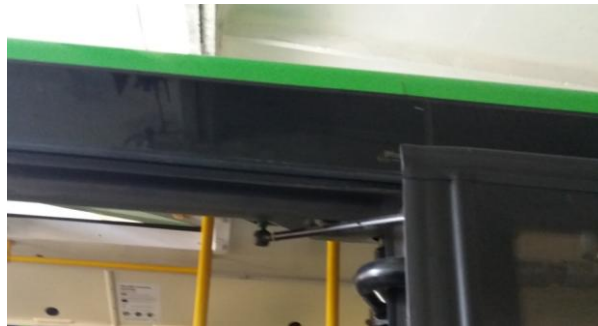
Рисунок 2.3 – Тріщина даху над передніми пасажирськими дверима
