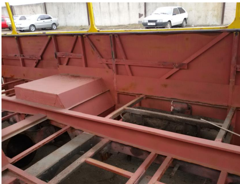
Рисунок 4.32 – Вигляд каркасу кузова автобуса «Богдан» А092 після ВР
