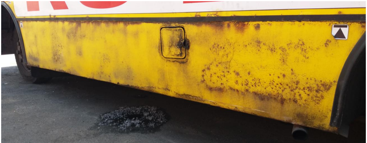
Рисунок 2.1 – Корозія бічних поверхонь автобуса «Богдан» А092
