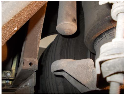
Рисунок 2.7 – Обірваний шток амортизатора задньої підвіски
