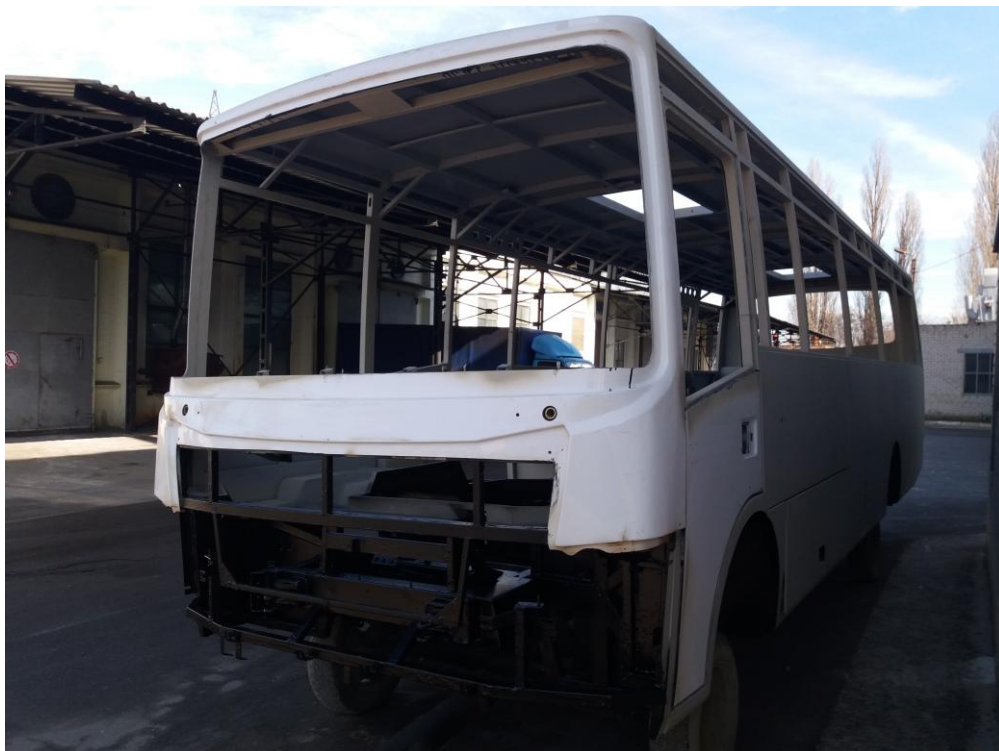
Рисунок 5.9 – Кузов автобуса, з привареним дахом та приклеєним облицюванням, підготовлений до подальших малярних робіт
