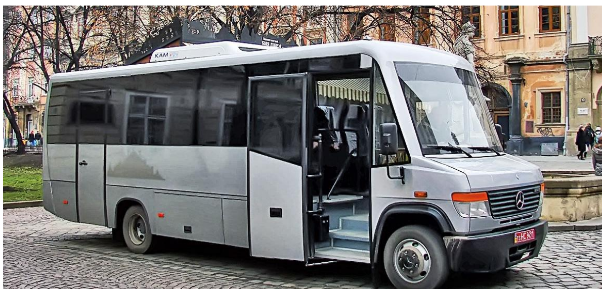
Рисунок 5.12 – Автобус ТУР А407, на якому облицювання виконується композитними матеріалами (типу Алюкобонд)
