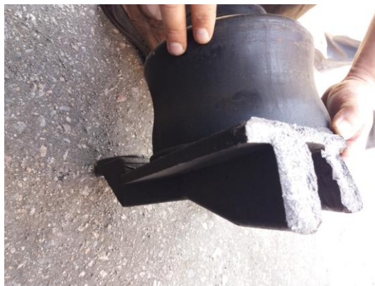
Рисунок 2.8 – Обламаний упор пневморесори задньої підвіски [79]
