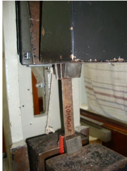
Рисунок 4.4 – Випробування зразків елементів каркасу кузова на розривній машині Р-5 згідно ISO 6892-1:2019
