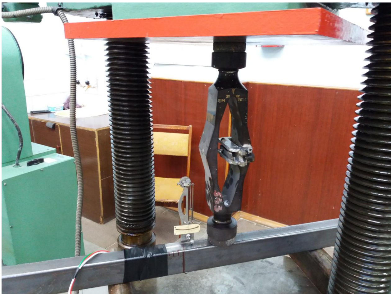
Рисунок 4.19 – Випробування зразка труби 60 \times 40 \times 3,0 мм
