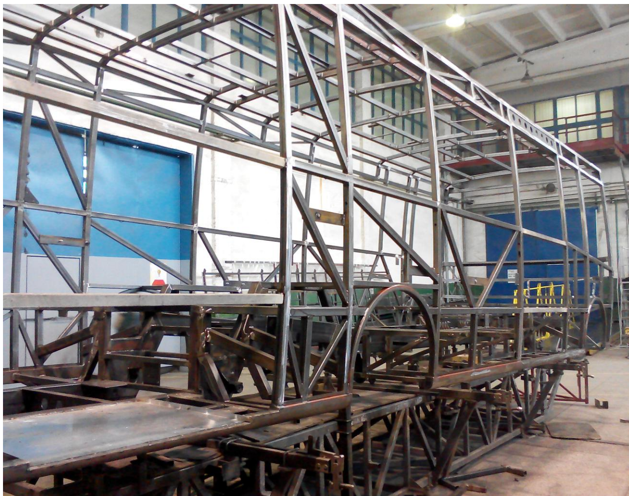
Рисунок 4.34 – Каркас кузова автобуса несівної конструкції під час зварювання в стапелі
