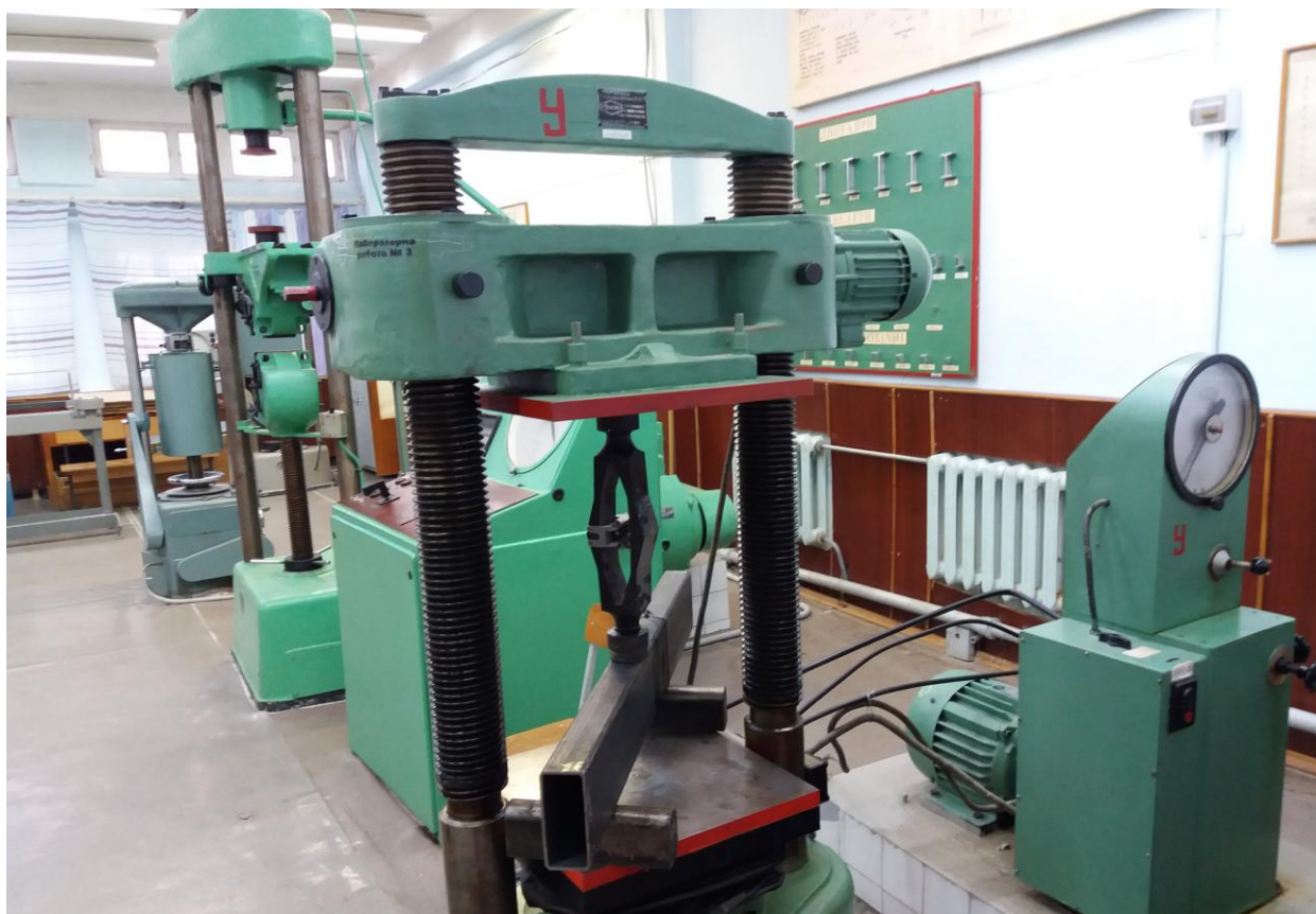
Рисунок 4.17 – Загальний вигляд пресу гідравлічного 2ПГ-125
