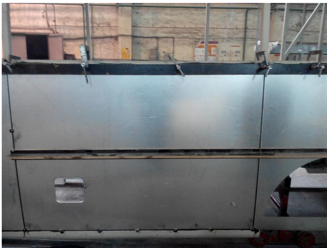
Рисунок 5.8 – Кузов автобуса з приклеєними бічними панелями із двостороннім покриттям цинку
