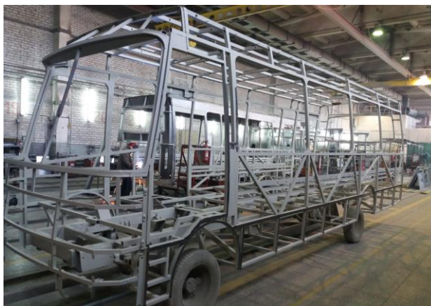
Рисунок 5.2 – КК автобуса після покриття високоадгезійним ґрунтом, де у місцях приварювання обшивки наклеюється малярна клейка стрічка
