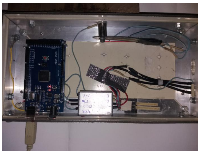
Рисунок 4.15 – Прилад для вимірювання деформації елементів каркасу кузова автобуса за допомогою зміни деформаційного опору
