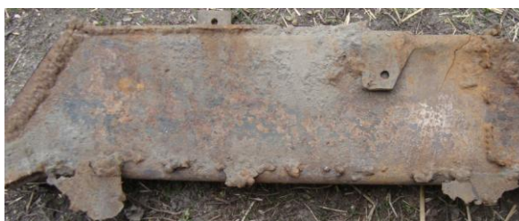
Рисунок 4.7 – Частина лонжерона основи каркасу кузова обраного для досліджень
