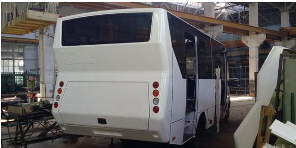
Рисунок 5.11 – Кузов автобуса, бічні панелі якого обшиті з полімерними листами з двостороннім покриттям алюмінієвої плівки (типу Алюкобонд)
