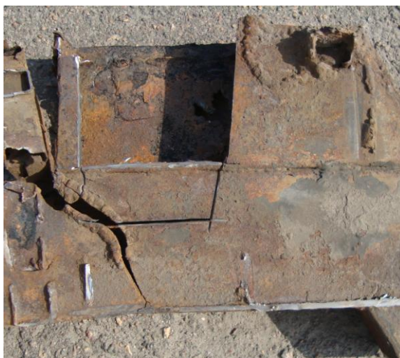
Рисунок 4.30 – Повторне руйнування лонжеронів каркасу основи профілю 140×60×3 мм автобуса «Богдан» А092 після заварювання втомної тріщини
