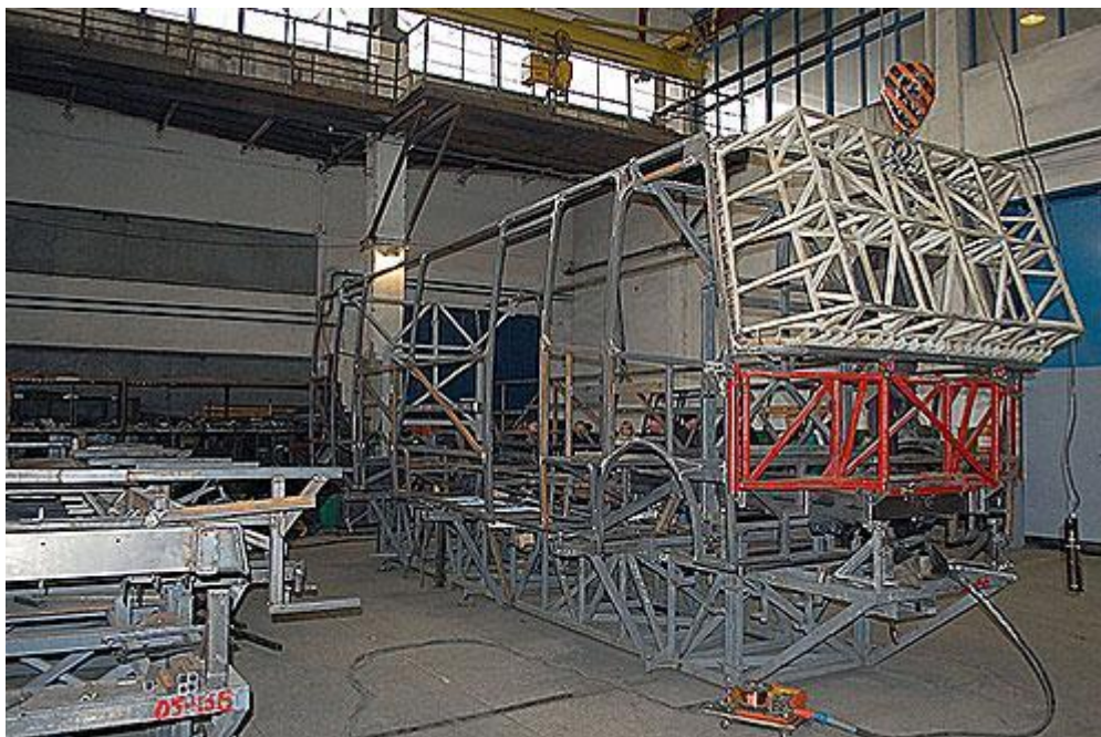
Рисунок 4.35 – Контроль пройми вітрового скла за допомогою спеціального шаблону
