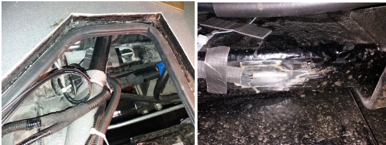
Рисунок 4.22 – Місця розміщення тензорезисторів
