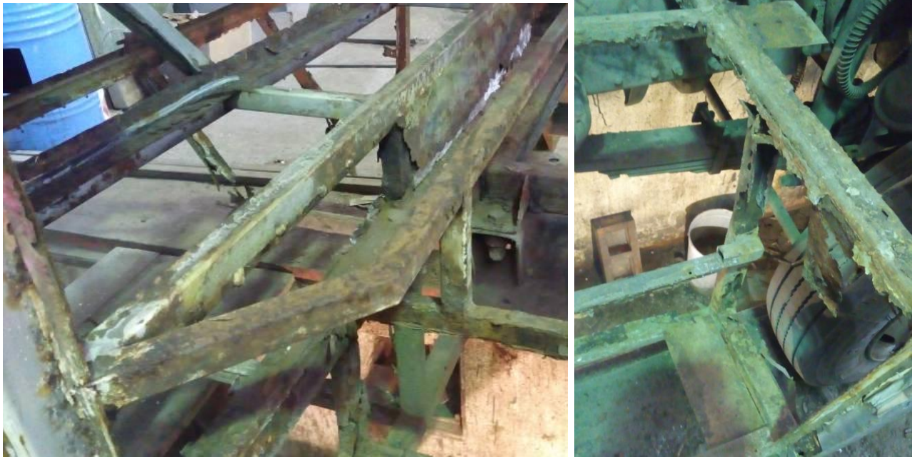
Рисунок 2.18 – Корозія каркасу автобуса «Еталон» А079 після семи років експлуатації: а) – задня частина автобуса б) – передня частина автобуса
