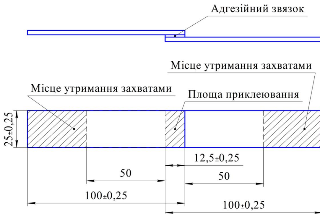
Рисунок 5.1 – Форма і розміри тестових зразків, що використовувались під час досліджень
