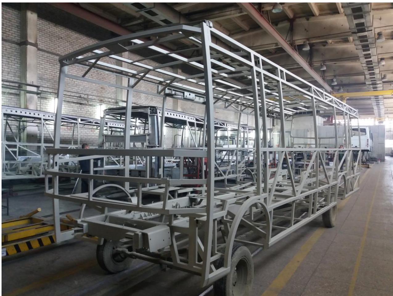
Рисунок 5.7 – КК автобуса, котрий покритий високоадгезійним антикорозійним ґрунтом
