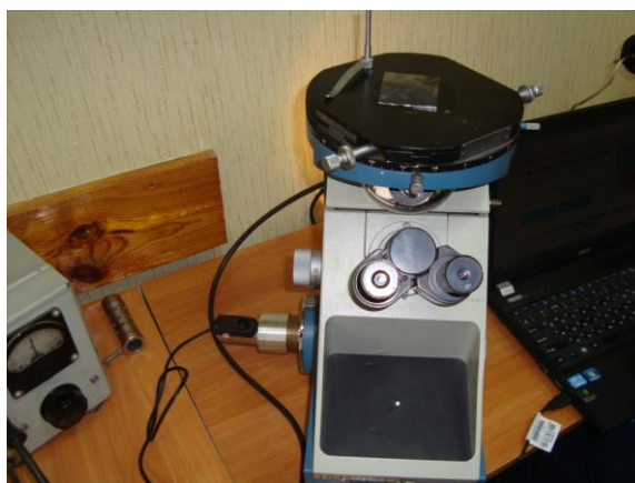
Рисунок 4.6 – Зовнішній вигляд металографічного мікроскопа ММР-2Р з допоміжним обладнанням під час експериментальних досліджень
