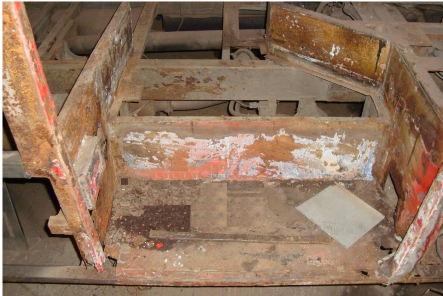
Рисунок 2.24 – Корозія каркасу передньої пасажирської сходинок автобуса «Богдан» А092 після дев'яти років експлуатації
