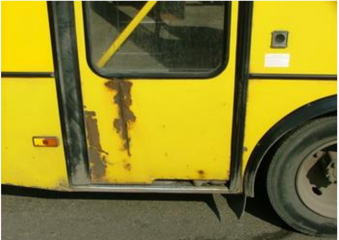
Рисунок 2.28 – Корозія облицювання задніх дверей автобуса «Еталон» [77]
