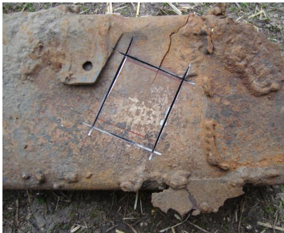
Рисунок 4.8 – Місце на лонжероні, звідки вирізаний зразок (у збільшеному вигляді)
