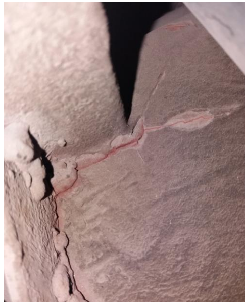
Рисунок 2.10 – Тріщини правого лонжерона перерізом 140 \times 60 \times 3 мм
