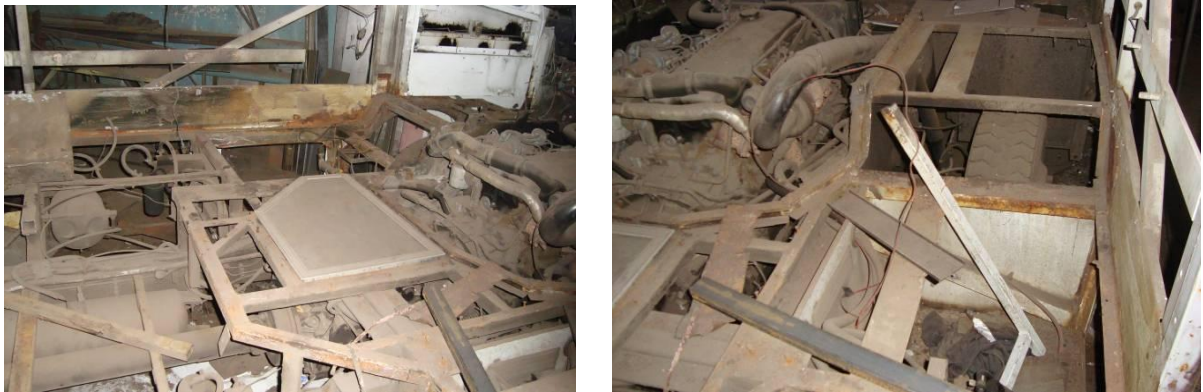
Рисунок 2.25 – Корозія каркасу моторного відсіку автобуса «Богдан» А092 після п'яти років експлуатації
