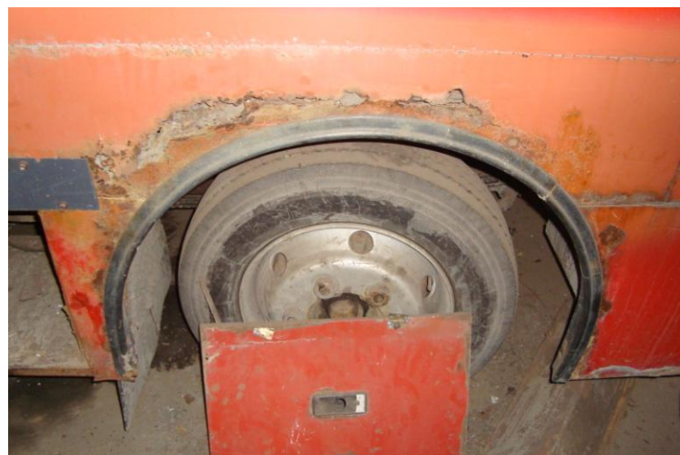
Рисунок 2.26 – Корозія облицювання автобуса «Богдан» А092 після дев'яти років експлуатації [84]
