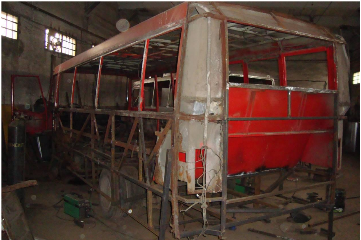
Рисунок 2.22 – Автобус «Богдан» А092 після дев'яти років експлуатації під час ремонту (заміна пошкоджених елементів каркасу)
