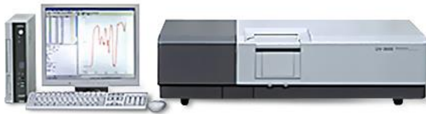
Рис. 2.10 Спектрофотометр SHIMADZU UV-3600 з можливістю вимірювати пропускання та відбивання плівок в діапазоні довжин хвиль 190 – 3600 нм.
