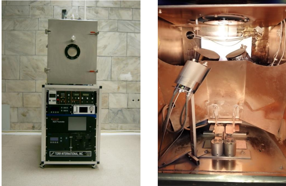
Рис. 5.6. Загальний вигляд установки термічного та магнетронного напилювання фірми «Torr International» (а) та її робочої камери (б).
