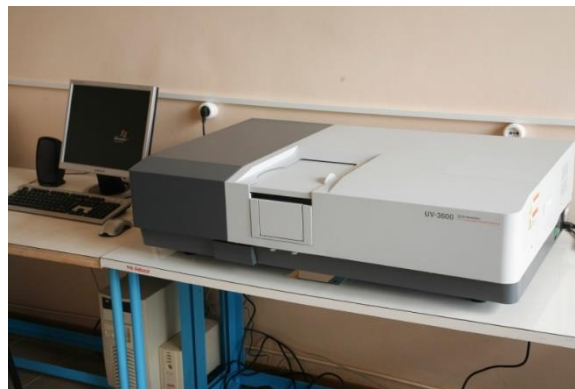
Рис. 5.24. Спектрофотометр Shimadzu UV3600 для реєстрації спектрів відбивання та пропускання оптичних покриттів
