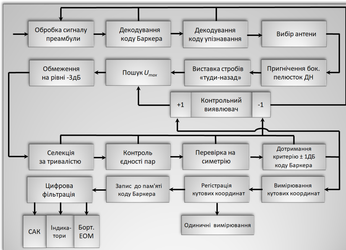
Рис. 6.13. Структура алгоритму для контролю достовірності бортових вимірювань куткових координат ПС
