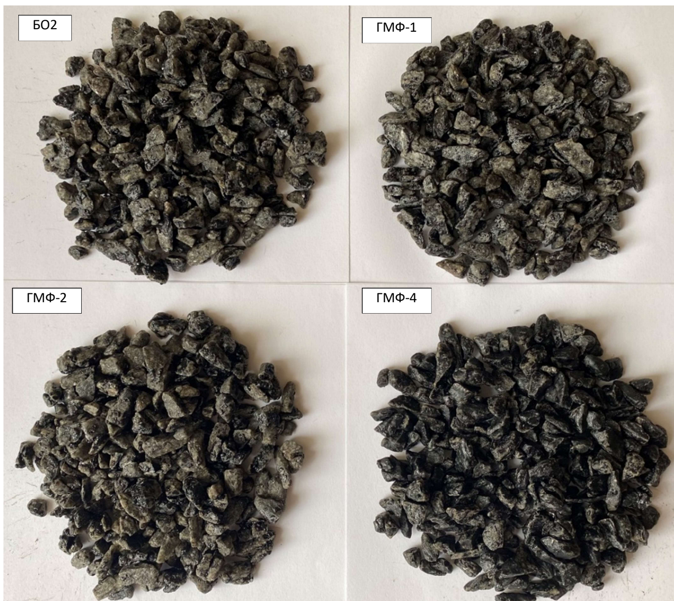
Рисунок 4.23 – Візуальна оцінка площі поверхні кислого заповнювача (Щ1), покритої БО2 і ГМФ через 48 годин обертання за методом RVT
