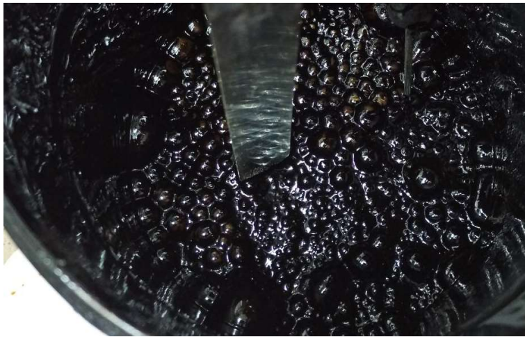
Рисунок 5.15 – Процес спінювання окисненого бітуму (БОЗ) МА
