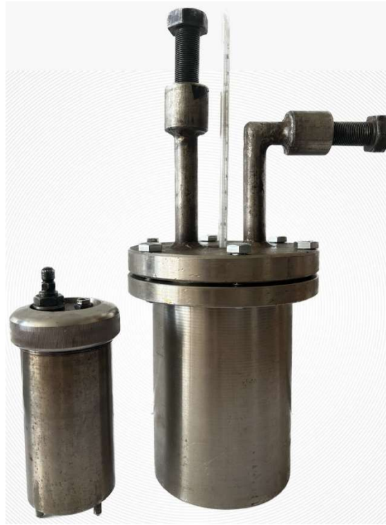
Рисунок 2.2 – Вигляд реакторів модифікування гудрону або бітуму формальдегідом без перемішування
