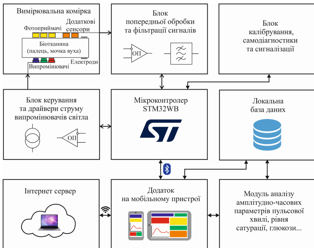
Рис. 6.26. Структурна схема гібридної сенсорної системи для біомедичних застосувань.
