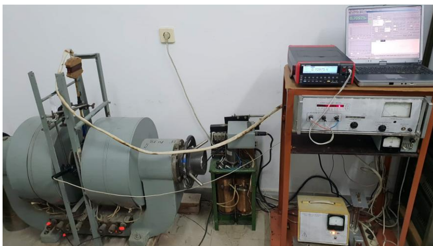
Рис. 2.6. Загальний вигляд установки автоматизованих вимірювань термоелектричних параметрів напівпровідників.
