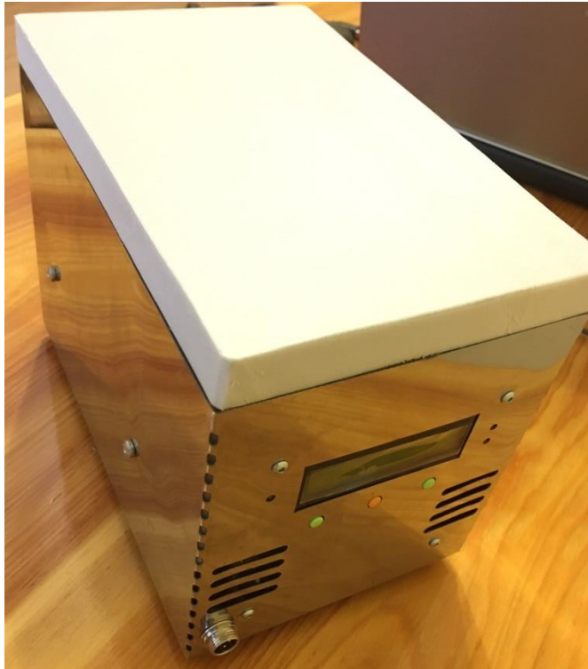
Рис. 6.21. Загальний вигляд діючого прототипу термоелектричного термостата.
