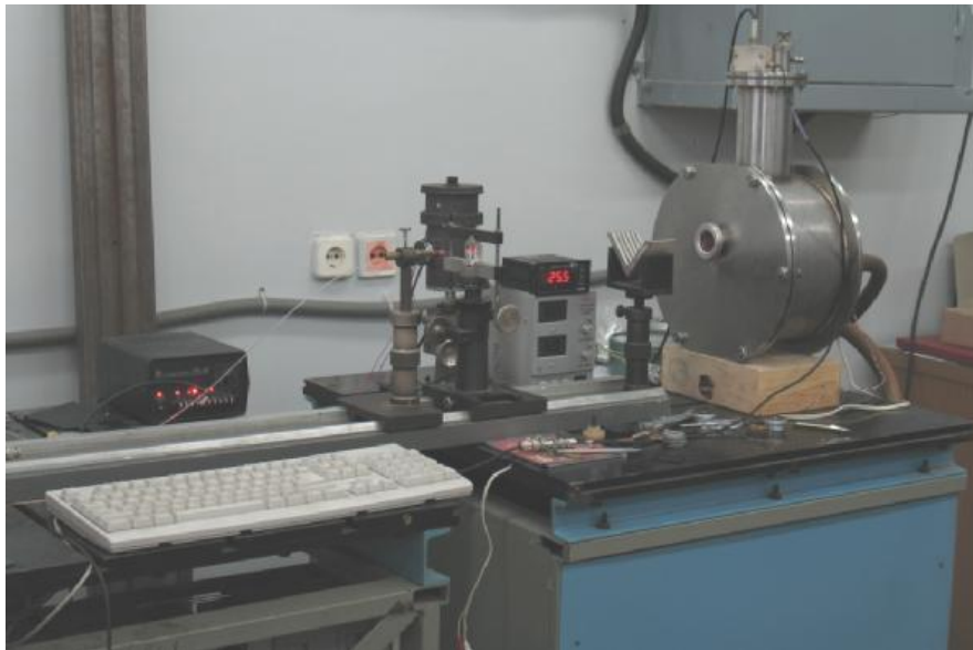
Рис. 1.12. Загальний вигляд установки для реалізації лазерного флеш-методу вимірювання теплопровідності тонких плівок [138].
