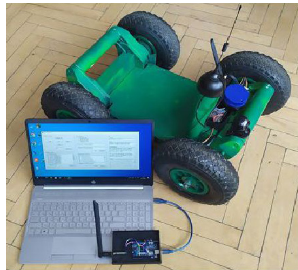
Експериментальна мобільна робототехнічна платформа з інтелектуальною системою управління та захистом передавання даних
