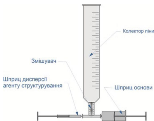
Принципова схема лабораторної установки з одержання спіненого гідрогелю
