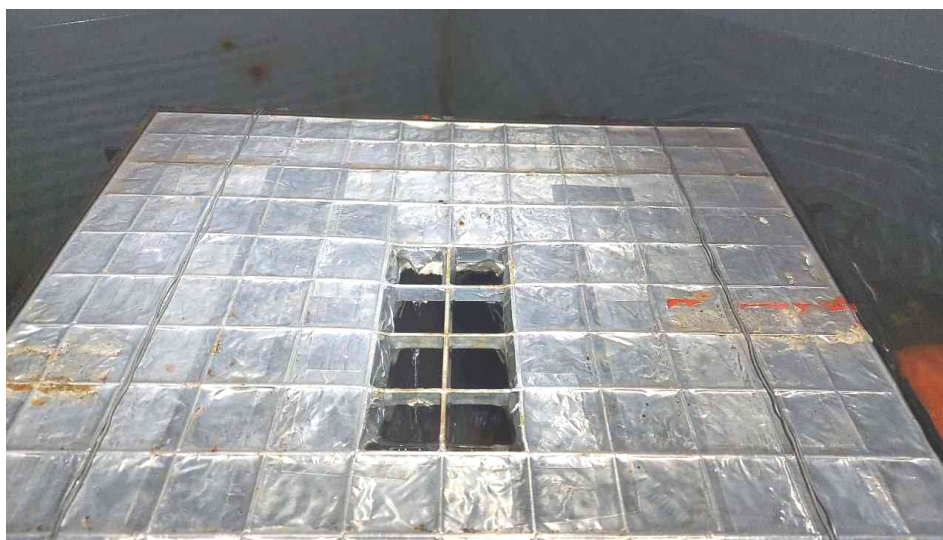
Рис. 4.39. Дощоприймач Basic 400 з решіткою №8 (131×65 мм) в режимі ВШП ( Q=0,99 л/с, h=14,4 мм)
