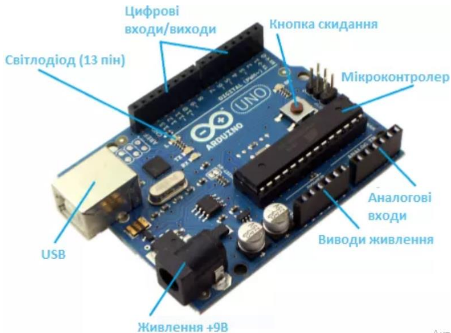
Рис.2.24. Основні елементи плати Arduino Uno
