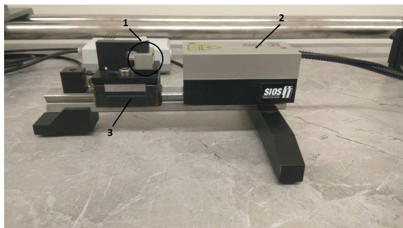
Рис.2.13. Установка компанії SIOS: 1 –дзеркальце, 2 - лазерний інтерферометр, 3 – підшипник на рейці
