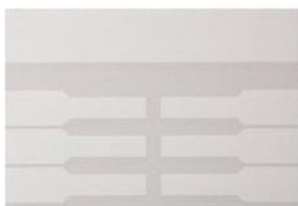
Рис. 2.11. Скляна підкладка із витравленим шаром ІТО
