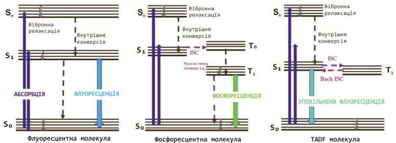
Рис. 1.2. Енергетична діаграма рівня, що демонструє основні процеси люмінесценції в емітерній молекулі (ліворуч: флуоресцентна молекула; в центрі: фосфоресцентна молекула; праворуч: молекула TADF). Неперервні стрілки вказують на випромінювальні процеси. Пунктирні стрілки представляють безвипромінювальну релаксацію.
