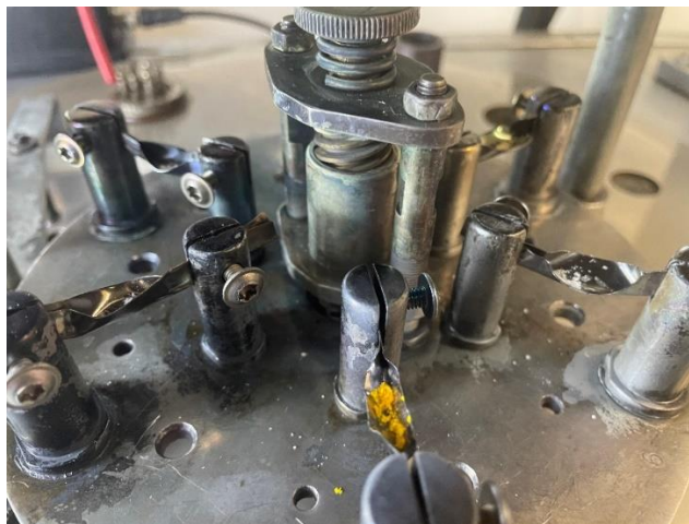
Рис.2.14. Карусель із випарниками установки термо-вакуумного напылення
