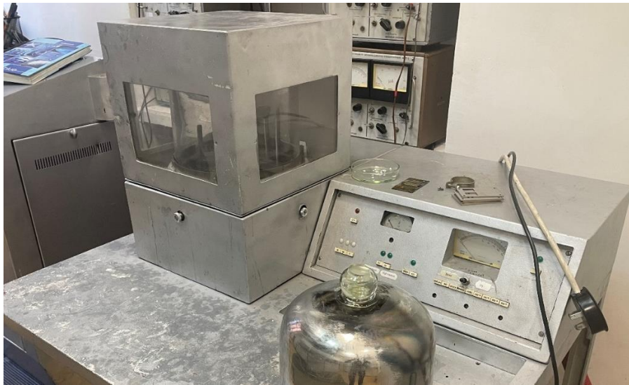
Рис. 2.13. Установка термо-вакуумного напыления металлических пленок ВУП-4, що використовувалася для формування металевого катоду OLED-структур
